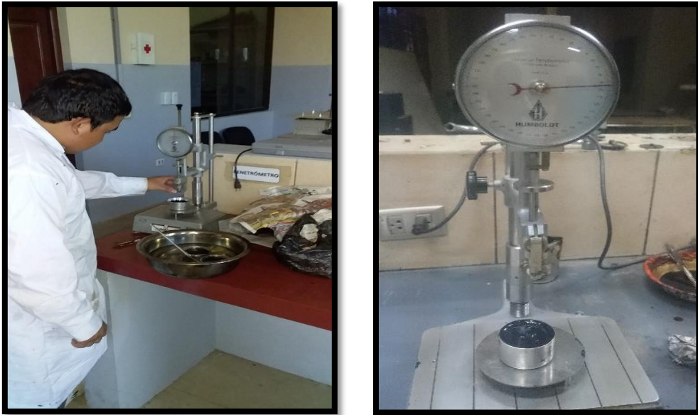
Figura 3.26. Realización de la penetración de la muestra
