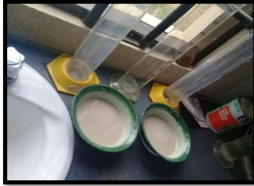
Figura 3.32. Preparación del caolín con defloculante
