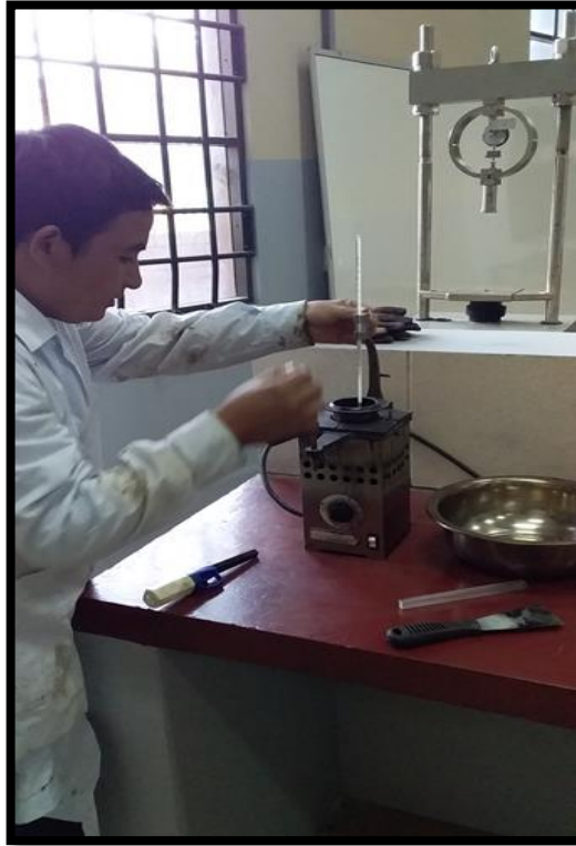
Figura 3.28. Realización del ensayo de punto de inflamación
