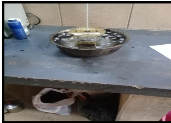
Figura 3.29. Realización del ensayo de punto de ablandamiento
