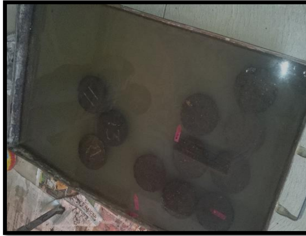
Figura 3.48. Briquetas sumergidas en baño maría a 60\text{ °C}
