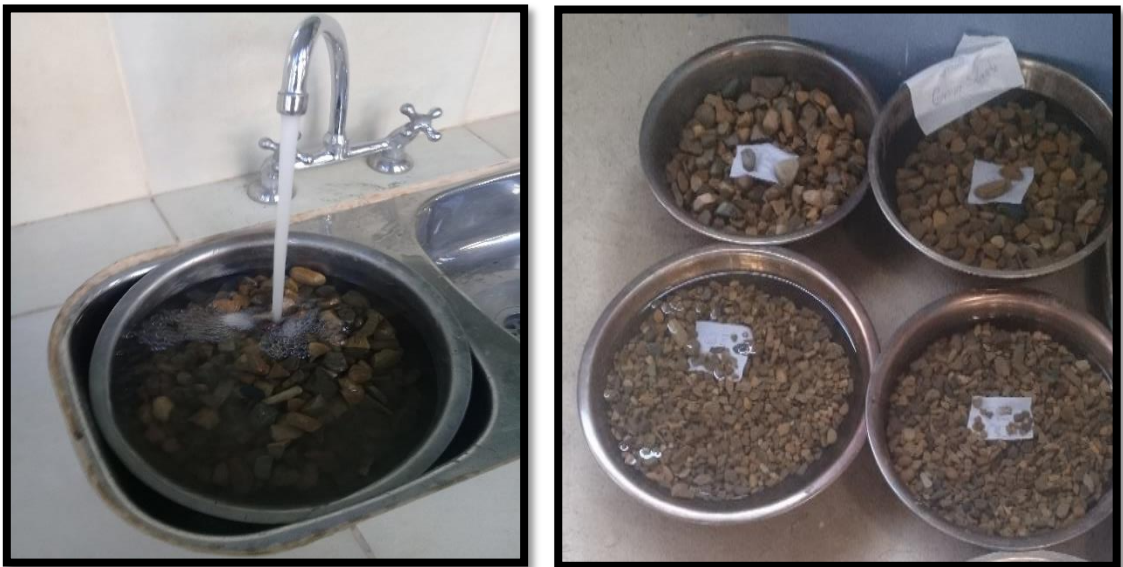
Figura 3.16. Muestra sumergida por 24 hrs.
