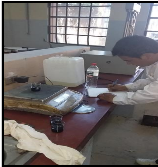
Figura 3.31. Determinación del peso del picnómetro + C.A. + agua
