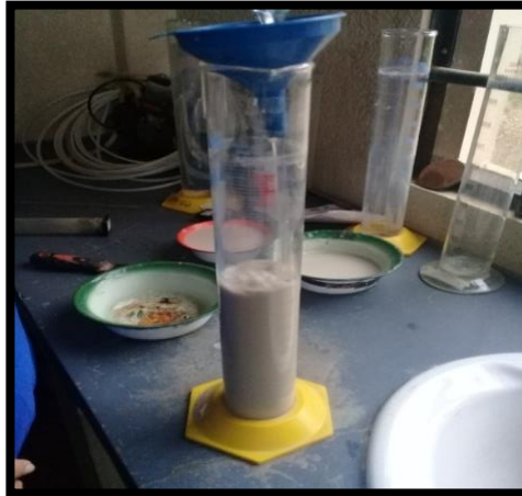
Figura 3.33. Vaciado del caolín a la probeta
