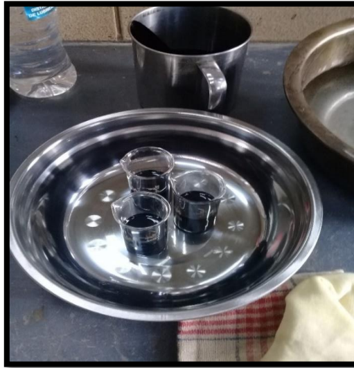
Figura 3.30. Picnómetros utilizados para determinar el peso específico
