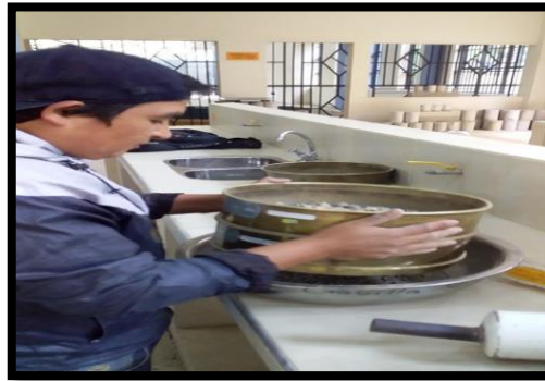
Figura 3.24. Preparación de material para el ensayo de desgaste de los ángeles
