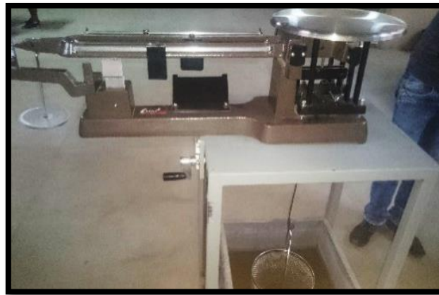
Figura 3.46. Determinación del peso sumergido
