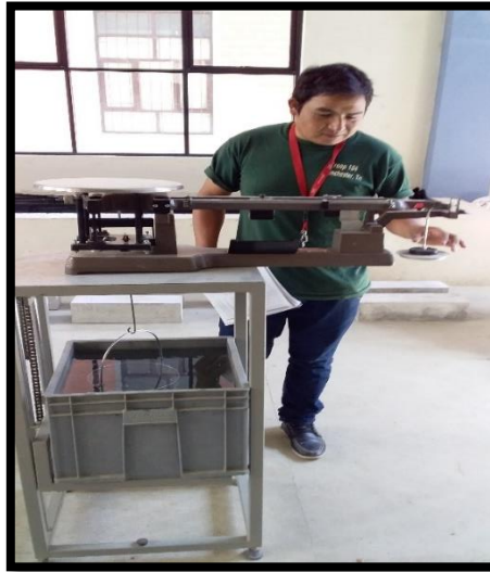
Figura 3.17. Obtención del peso sumergido de la muestra
