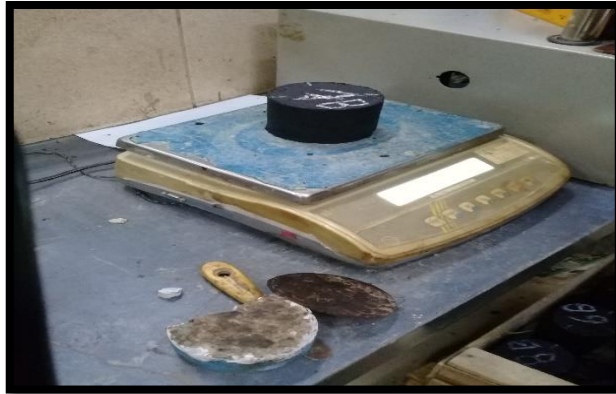
Figura 3.45. Determinación del peso de la briqueta en estado seco
