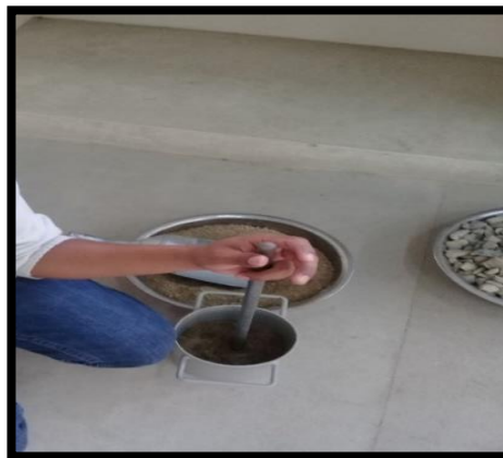
Figura 3.22. Peso unitario del agregado fino (arena)
