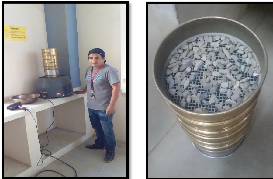
Figura 3.6. Tamizado mediante los tamices normalizados ASTM
