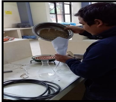
Figura 3.19. Muestra con humedad superficialmente seca
