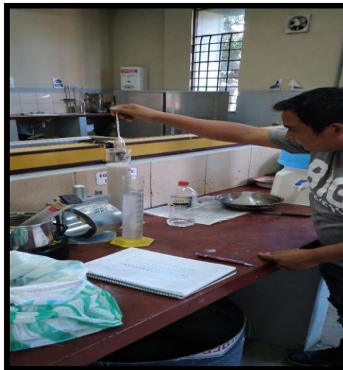
Figura 3.34. Lectura del hidrómetro
