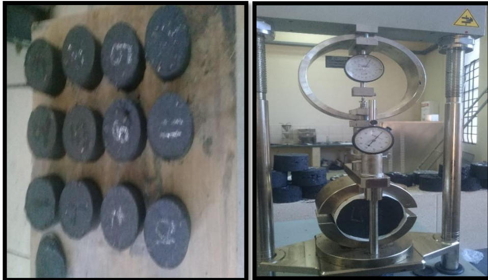
Figura 3.49. Determinación de la estabilidad y fluencia de las briquetas
