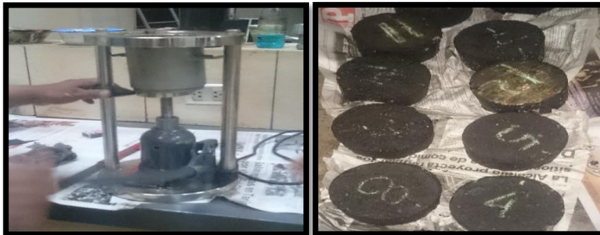
Figura 3.43. Extracción de las briquetas de los moldes
