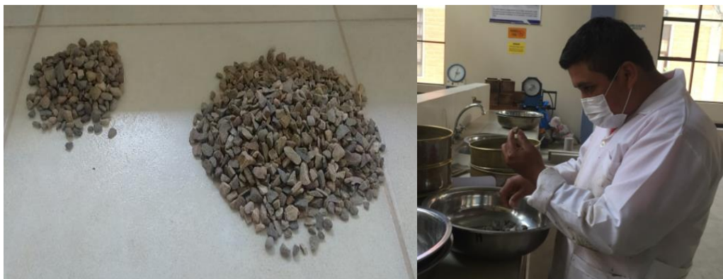
Figura 3.21: Partículas de caras fracturadas.
