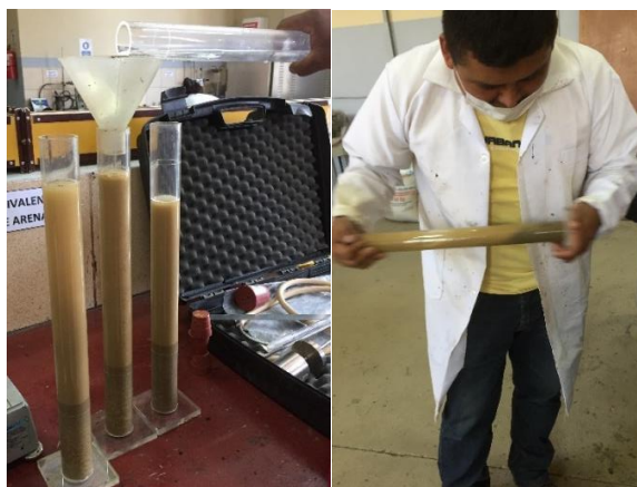
Figura 3.15: Equivalente de Arena y agitación del cilindro graduado con la muestra.
