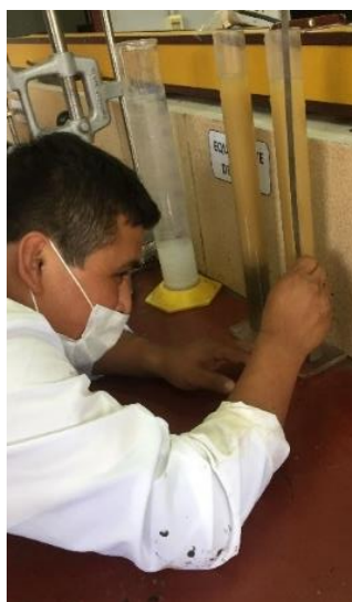
Figura 3.16: Lectura de la altura de arena que contiene
