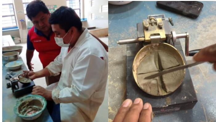
Figura 3.29: Colocado y retiro de la muestra en el aparato de casa grande
