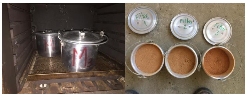
Figura 3.1: Proceso de la obtención del nuevo filler.
