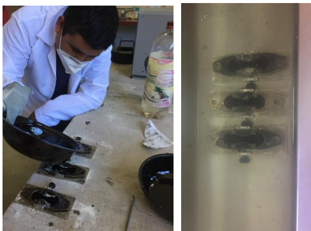
Figura 3.27: Realización del ensayo de ductilidad del cemento asfáltico.
