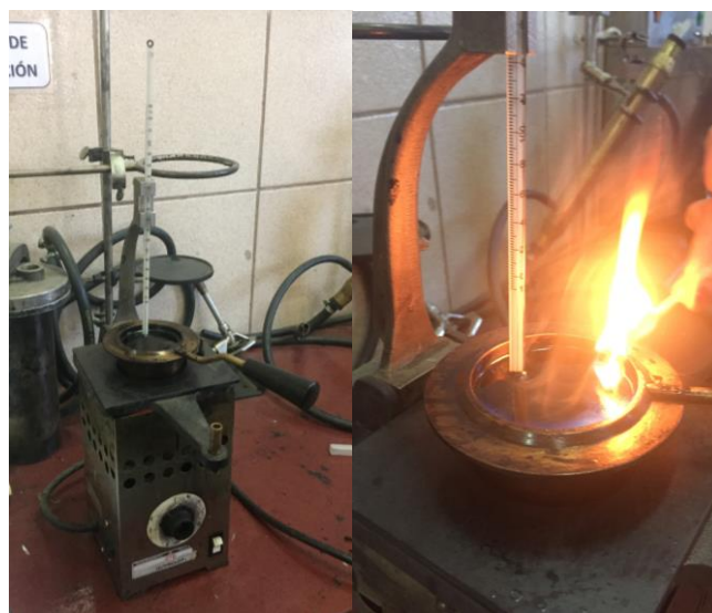
Figura 3.24: Realización del ensayo punto de inflamación del cemento asfáltico.
