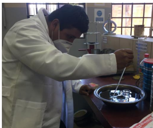
Figura 3.25: Realización del ensayo peso específico del cemento asfáltico.
