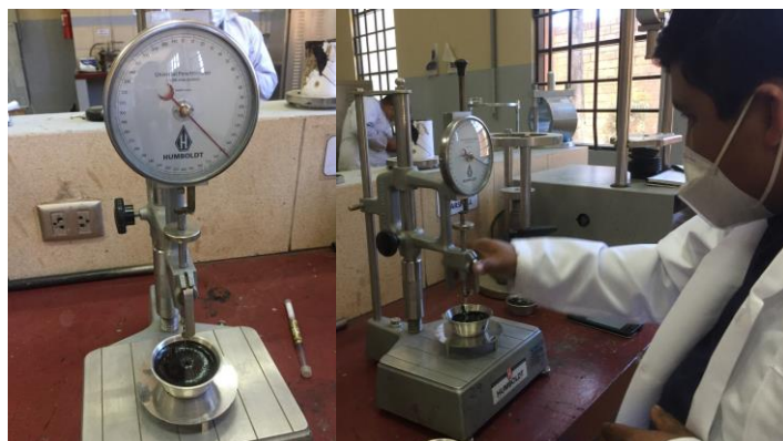
Figura 3.23: Realización del ensayo de penetración del cemento asfáltico.
