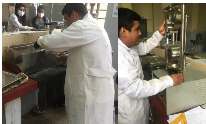
Figura 3.36: Ensayo de Estabilidad y Fluencia.
