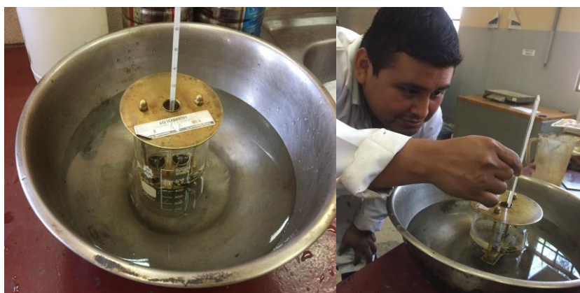
Figura 3.26: Ensayo punto de ablandamiento.
