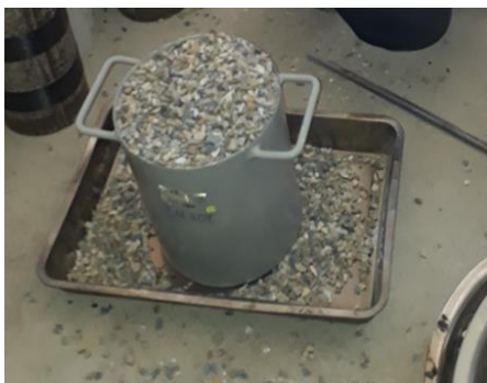
Figura 3.17: Peso unitario compactado del agregado 3/4”.
