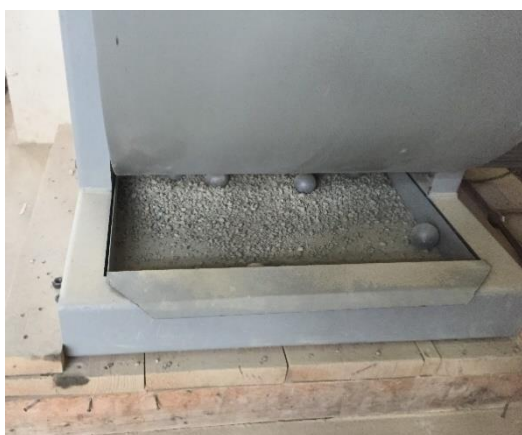
Figura 3.18: Máquina de desgaste por abrasión y material ensayado.
