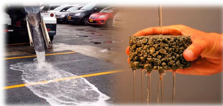
Figura 2.5: Extracto de mezcla asfáltica permeable.
