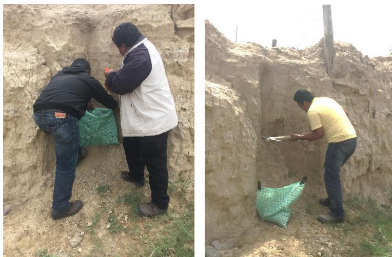
Figura 3.9. Extracción de muestra del banco 3, barrio Monte Cristo.
