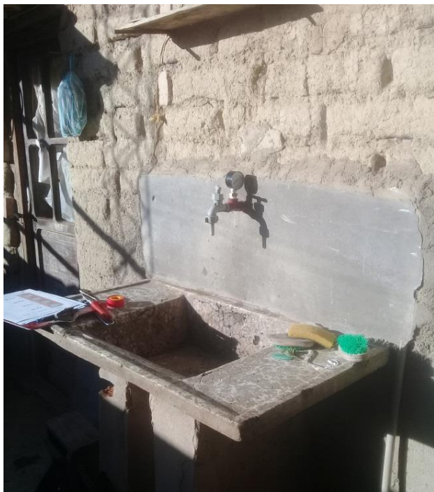
Figura 3.11 Instalación del manómetro en el nudo n25
