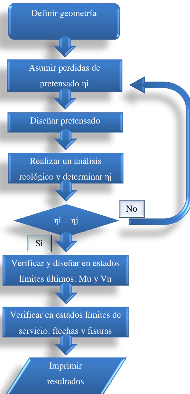
FIGURA N°7: Procedimiento de cálculo de una viga pretensada
