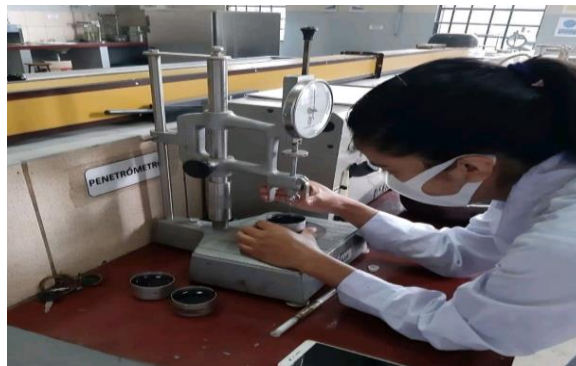
Figura 3.10: Ajuste de la aguja para ensayar la penetración
