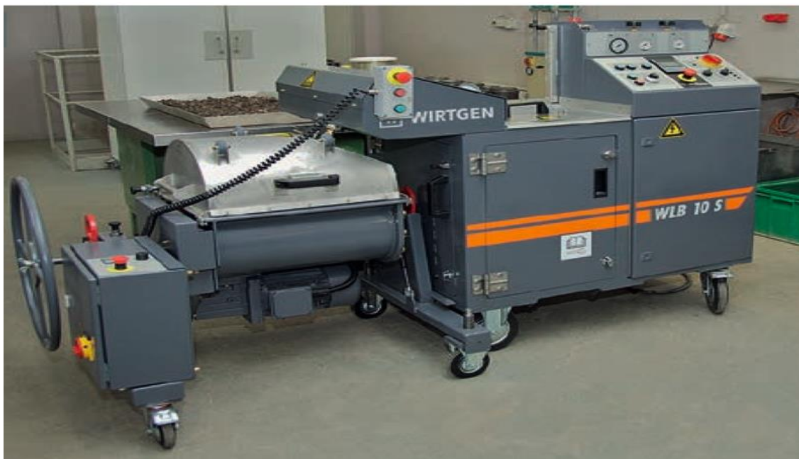
Figura 2.13: Con la ayuda del equipo de laboratorio WLB 10 S se pueden realizar series de mediciones para determinar las propiedades del betún espumado.
