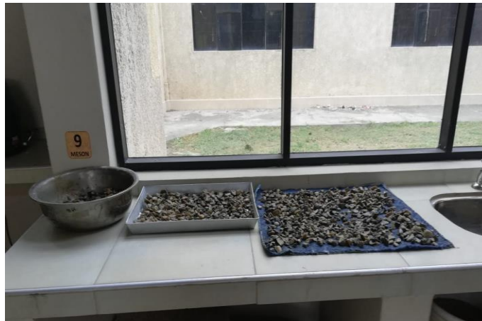
Figura 3.6: Secado superficial de la gravilla
