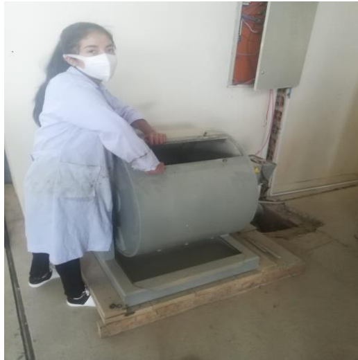
Figura 3.8: Vaciado de la gravilla luego de usar la máquina de desgaste de los ángulos
