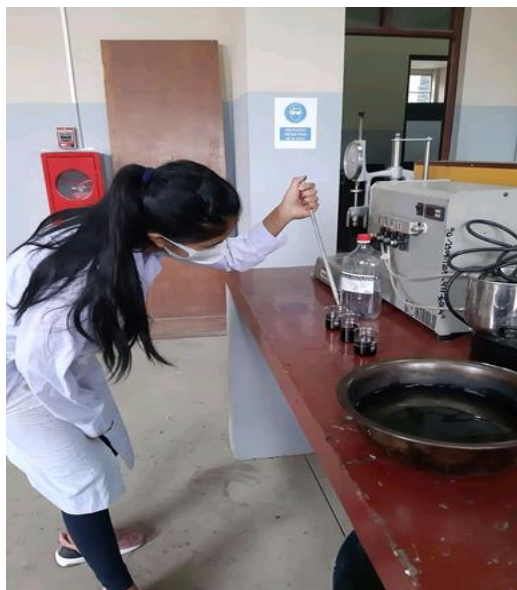
Figura 3.11: Preparando las muestras a ensayar para el peso específico
