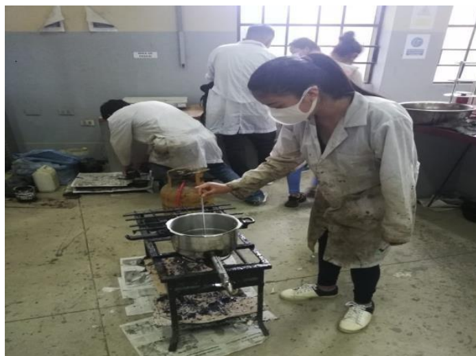
Figura 3.16: Control de temperatura del asfalto en la cámara de expansión
