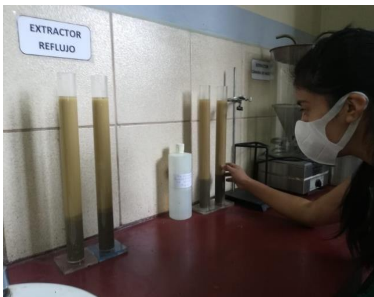
Figura 3.9: Observando la suspensión de la arcilla en el equivalente de arena
