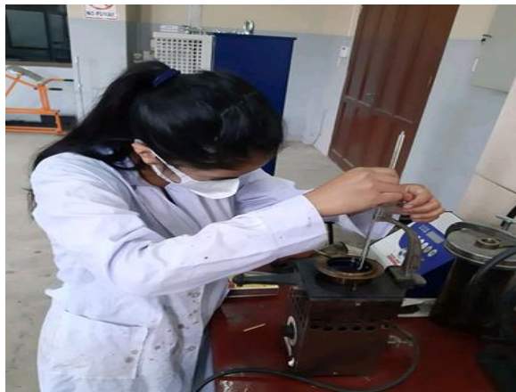
Figura 3.12: Ajustando el termómetro para el punto de inflamación
