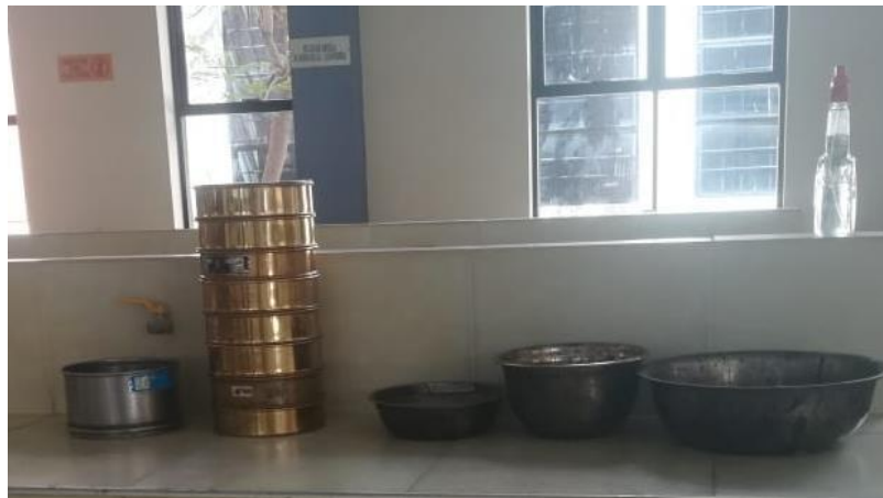
Figura 3.3: Granulometría del agregado grueso
