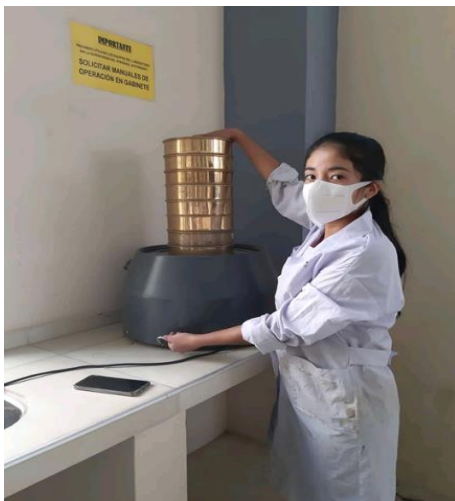
Figura 3.1: Granulometría del agregado fino
