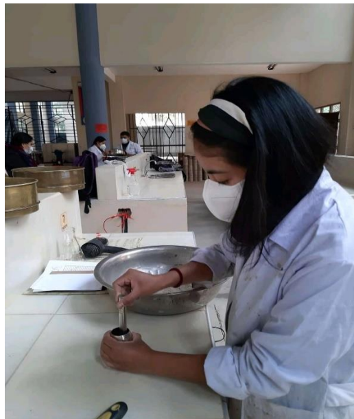
Figura 3.4: Eliminación de vacíos de la muestra
