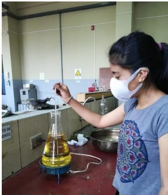
Figura 3.15: Controlando la temperatura del aceite para introducir el viscosímetro
