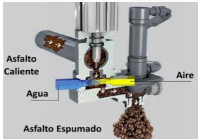
Figura 2.12: Sistema de producción del asfalto espumado
