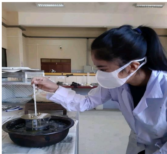
Figura 3.13: Controlando la temperatura para el punto de ablandamiento
