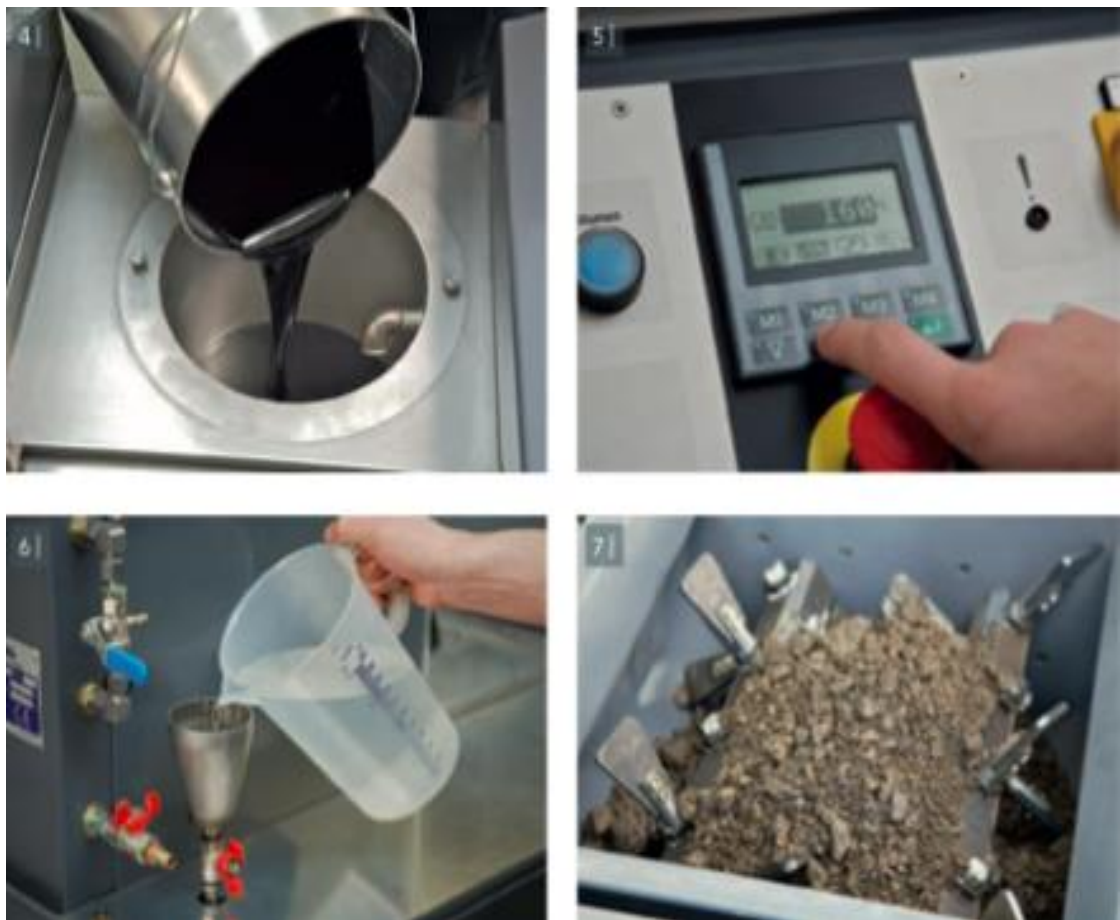
Figura 2.14: Es posible producir con facilidad diferentes clases de betún espumado para luego determinar la composición ideal.
