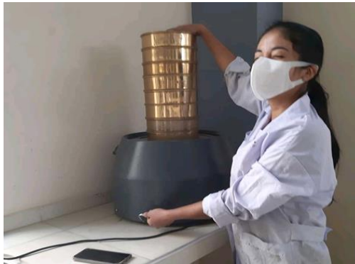
Figura 3.2: Granulometría del agregado grueso
