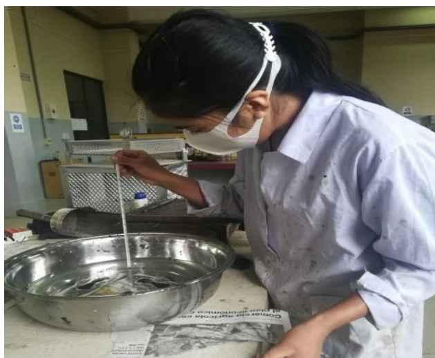
Figura 3.14: Controlando la temperatura para la ductilidad
