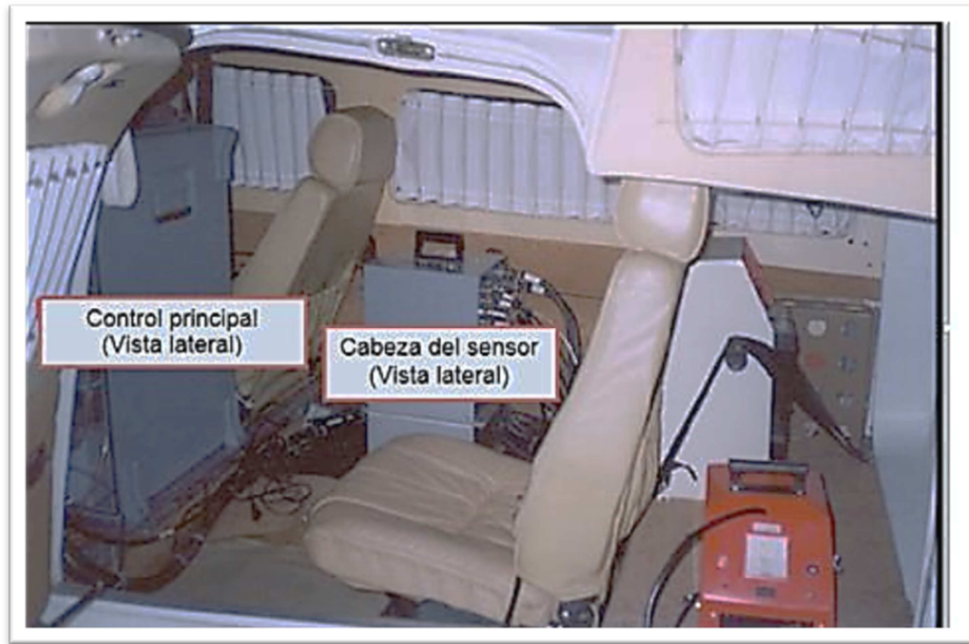
FIGURA 25. Ubicación del equipo LIDAR en el interior de la aeronave
