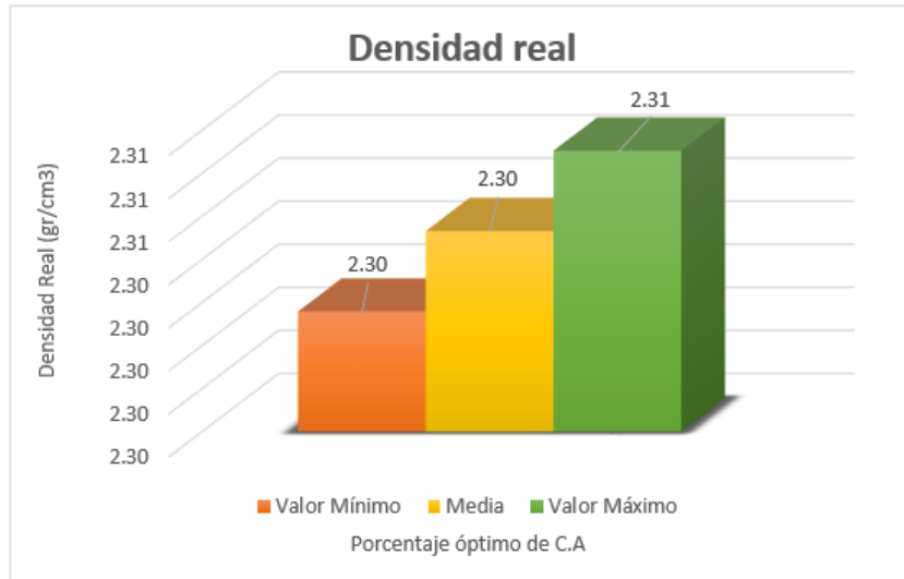
Gráfica 15. Densidad real para el diseño de la mezcla asfáltica Superpave
