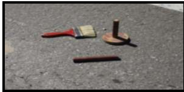
Imagen 1.7:4 Ensayo mancha de arena
