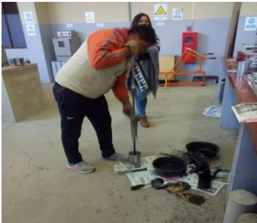
Figura 3. 6. Compactando de briquetas con óptimos finales.
