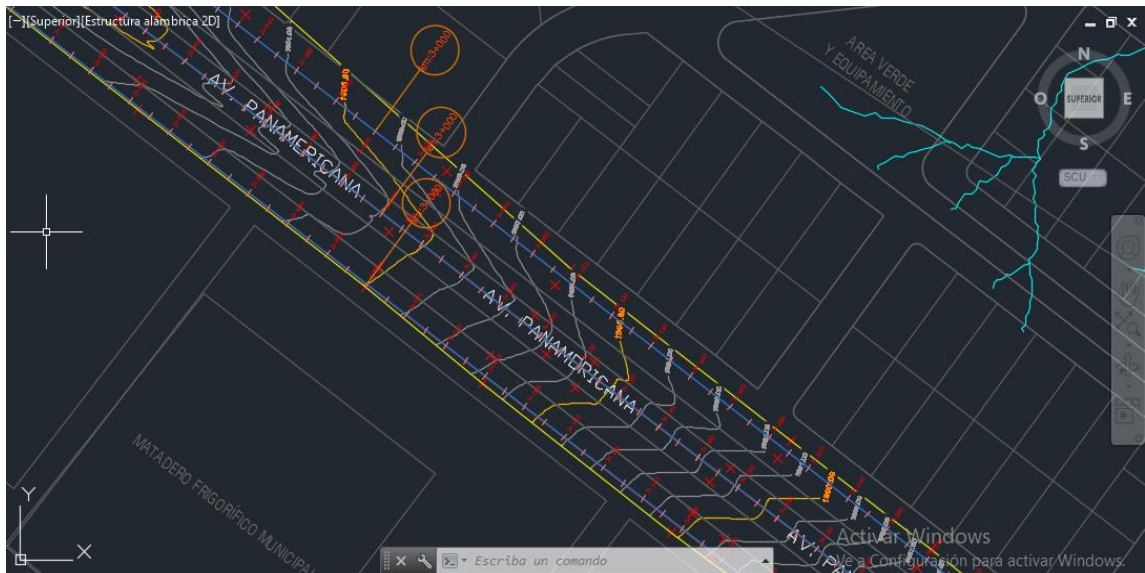
Figura N° 36: Detalle de levantamiento topográfico de la vía.
