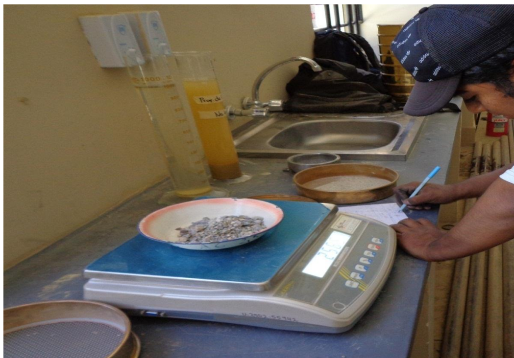
Figura 60 Pesado del material retenido en el tamiz N.- 12
