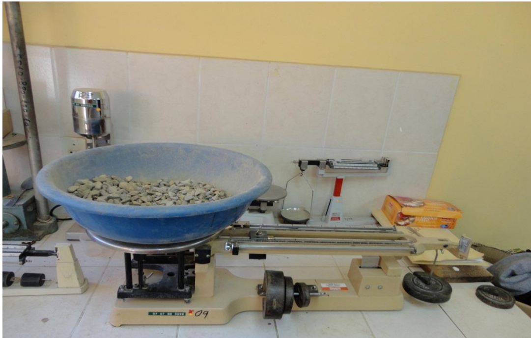
Figura 30 Pesado de la muestra en la balanza (muestra = 5000gr)
