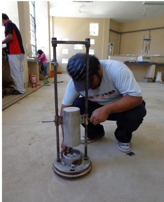
Figura 53 Ubicación del molde en el equipo de Fragmentación dinámica II
