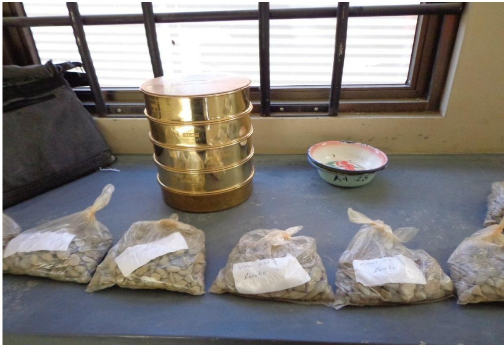
Figura 46 Muestras obtenidas de cada ensayo de desgaste de los Ángeles
