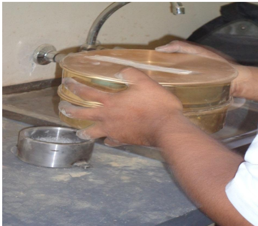
Figura 57 Tamizado del material ensayado en el tamiz N.- 12
