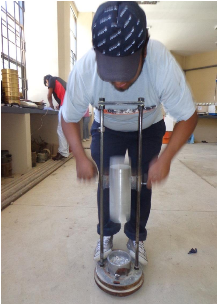
Figura 54 Realización del ensayo de fragmentación dinámica
