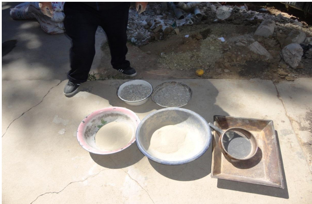
Figura 41 Muestra separada por tamiz N.- 12 I
