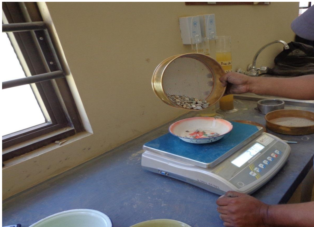
Figura 59 Vaciado del material retenido en el tamiz N.- 12 para su pesado
