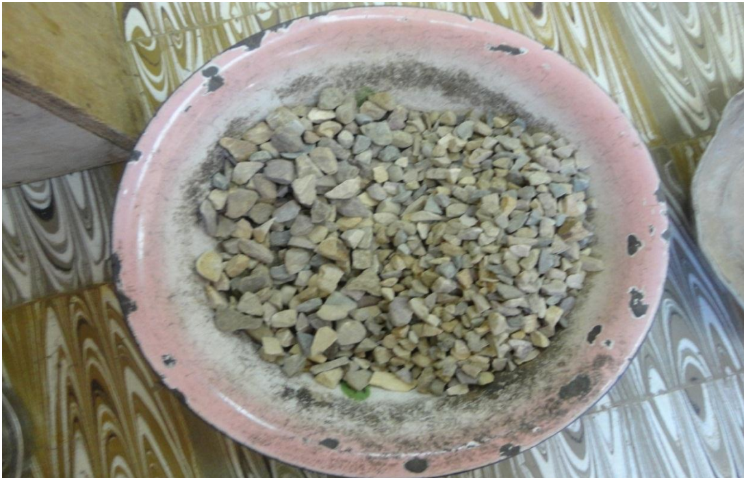
Figura 26 Preparación de muestra franja B I peso 5000 gr
