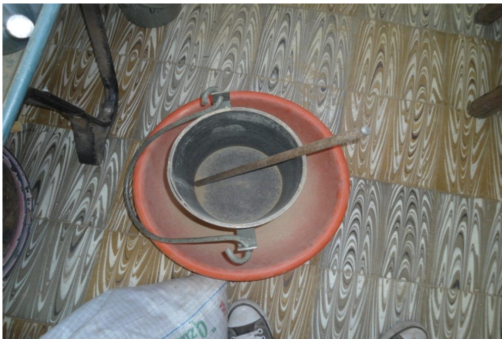
Figura 23 Molde y Varilla Usados para el ensayo de Peso Unitario (SEDECA)
