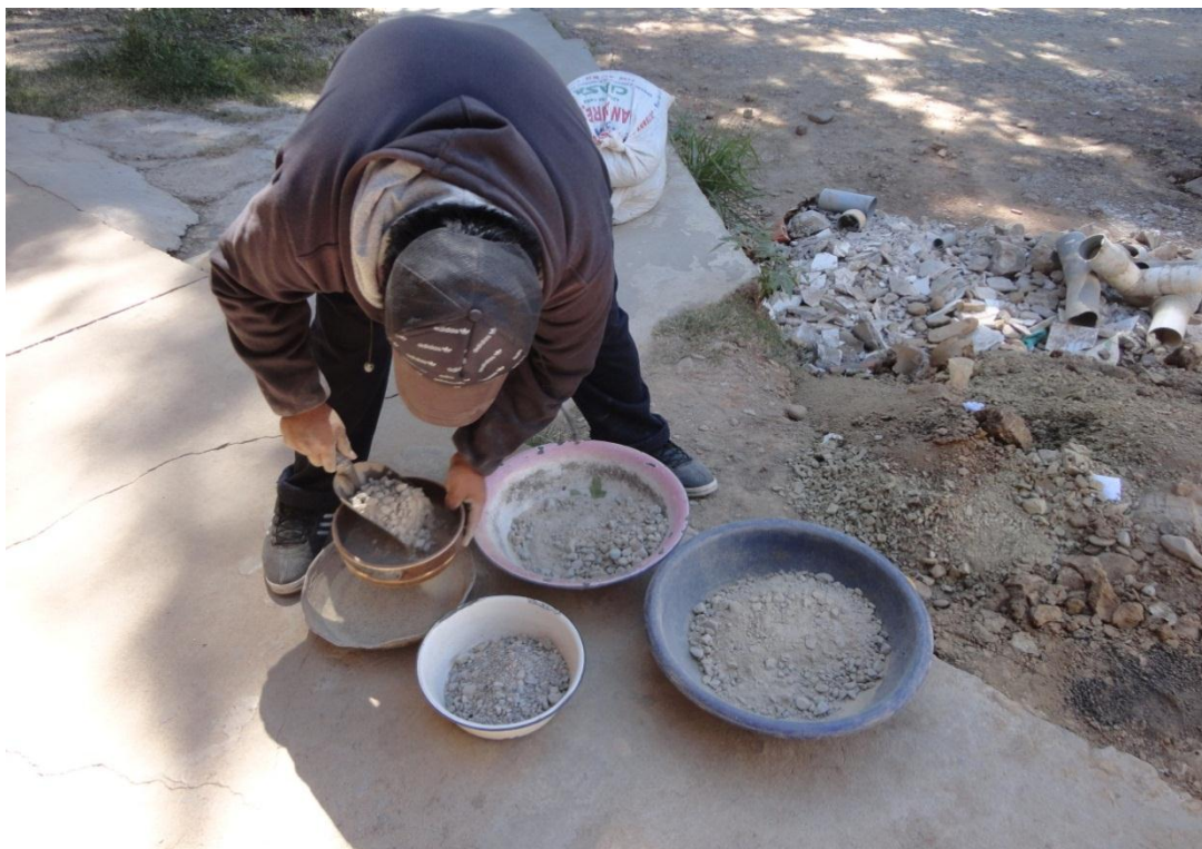
Figura 39 Tamizado en el tamiz N.- 12 I
