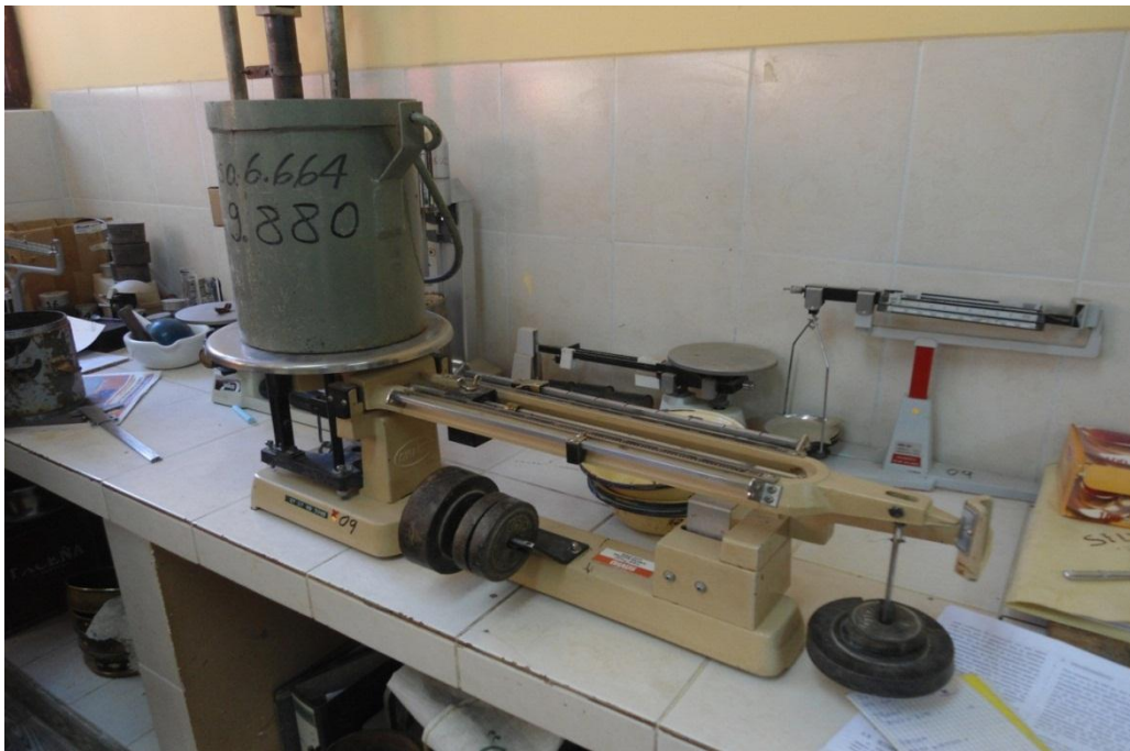
Figura 22 Pesado de la muestra en el molde
