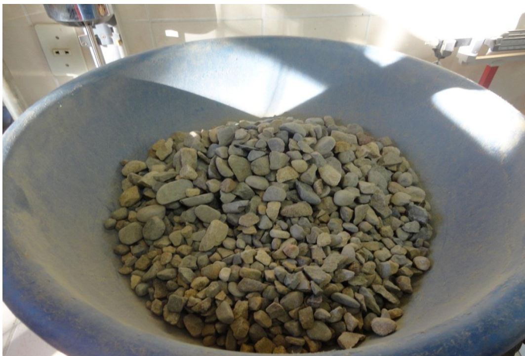
Figura 29 Mezclado del material para su posterior pesado
