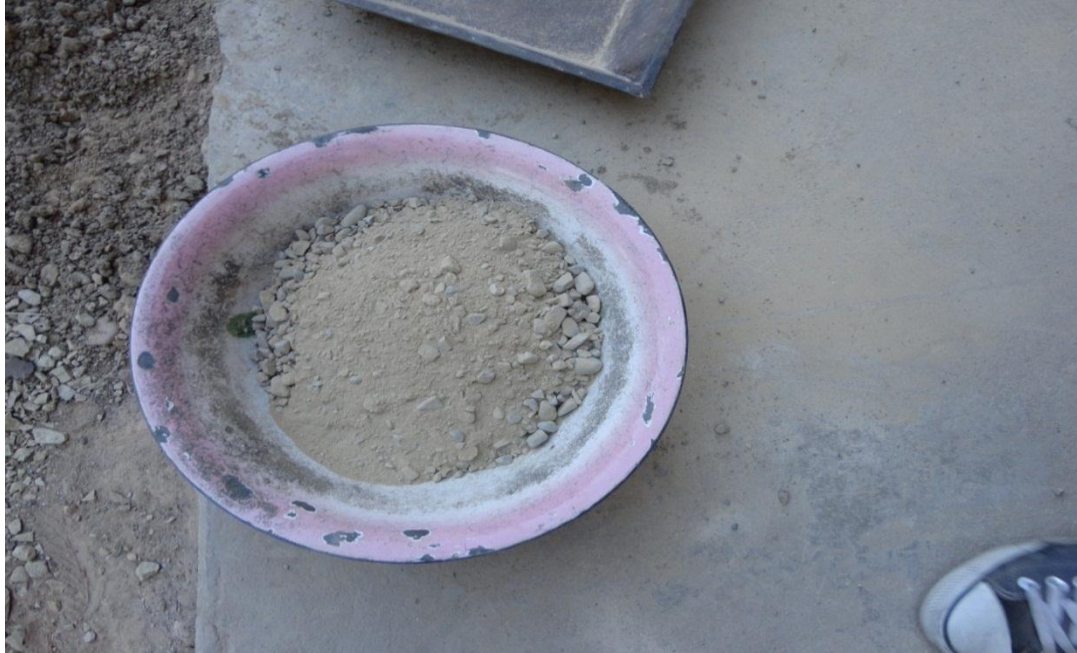
Figura 36 Material extraído de la máquina de los ángeles II
