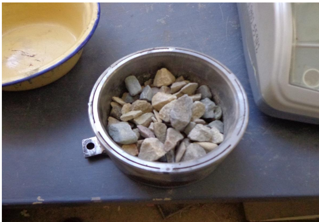
Figura 51 Colocado de la muestra en el molde
