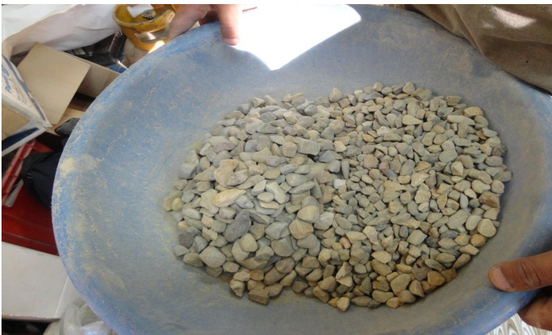
Figura 27 Preparación de muestra franja B II peso 5000 gr
