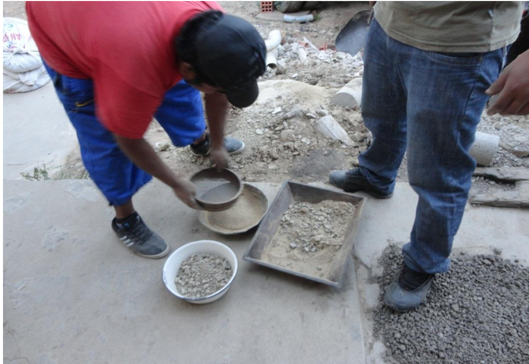
Figura 40 Tamizado por el tamiz N.- 12 II
