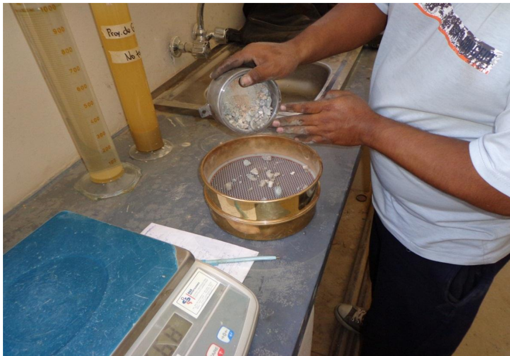
Figura 56 Vaciado del material ensayado en el tamiz N.- 12
