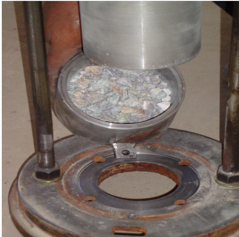
Figura 55 Extracción del molde con el material ensayado
