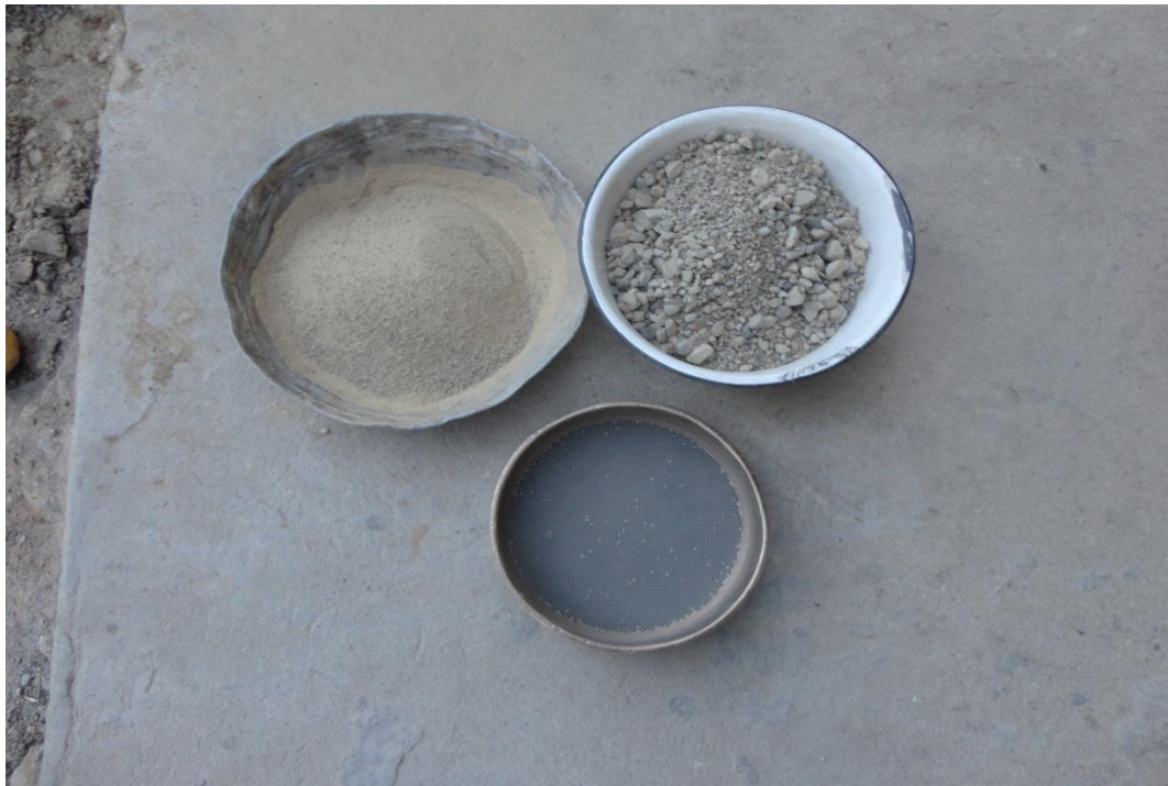
Figura 42 Muestra separada por tamiz N.- 12 II
