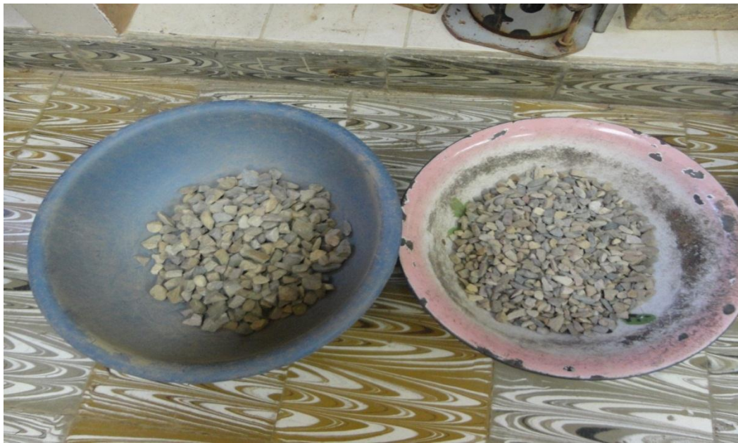
Figura 24 Preparación de la muestra para introducir a la máquina de los ángeles
