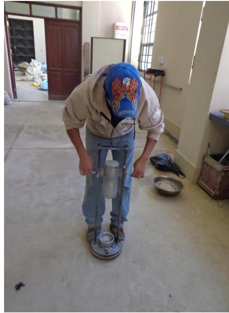
Figura 54 Realización del ensayo de fragmentación dinámica
