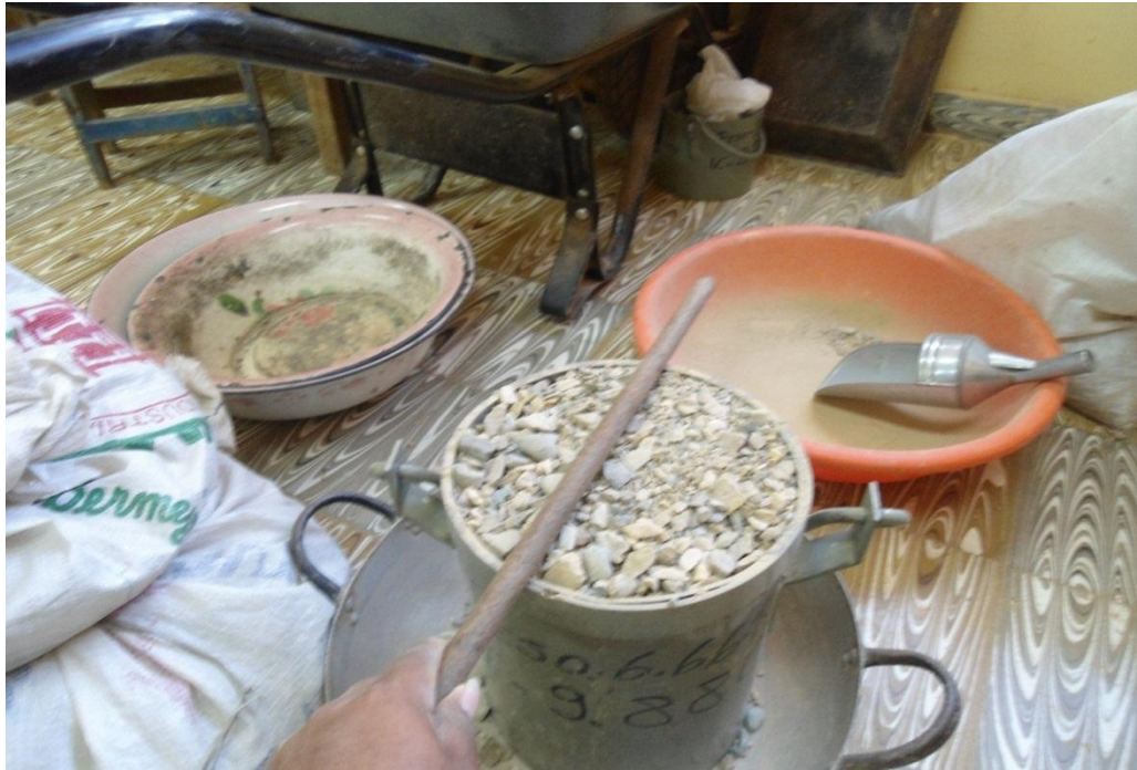
Figura 21 Enrasado en el molde de los Agregados
