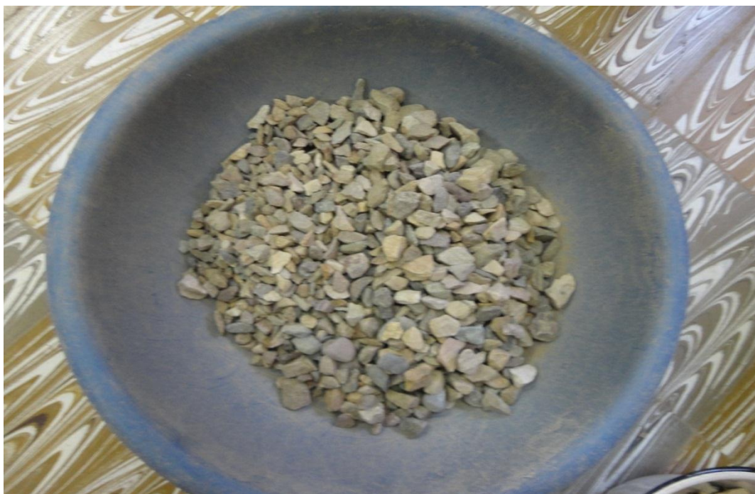
Figura 28 Preparación de muestra franja B III peso 5000 gr
