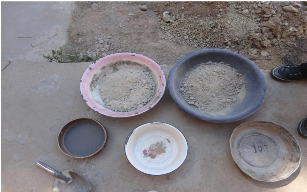
Figura 35 Material extraído de la máquina de los ángeles I
