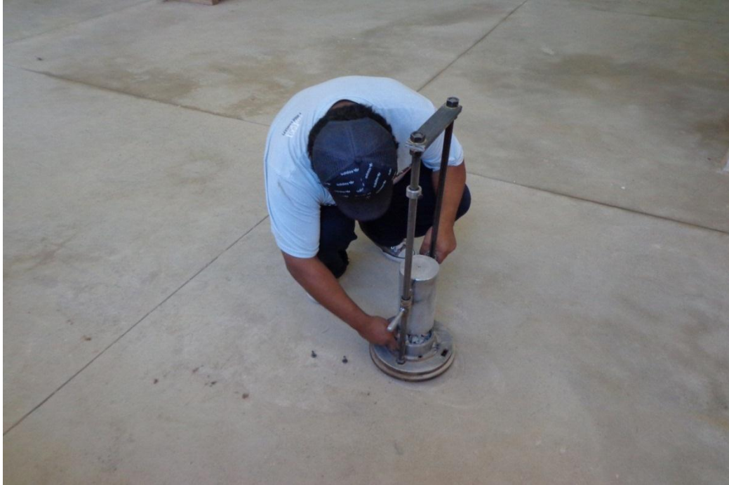
Figura 52 Ubicación del molde en el equipo de Fragmentación dinámica I
