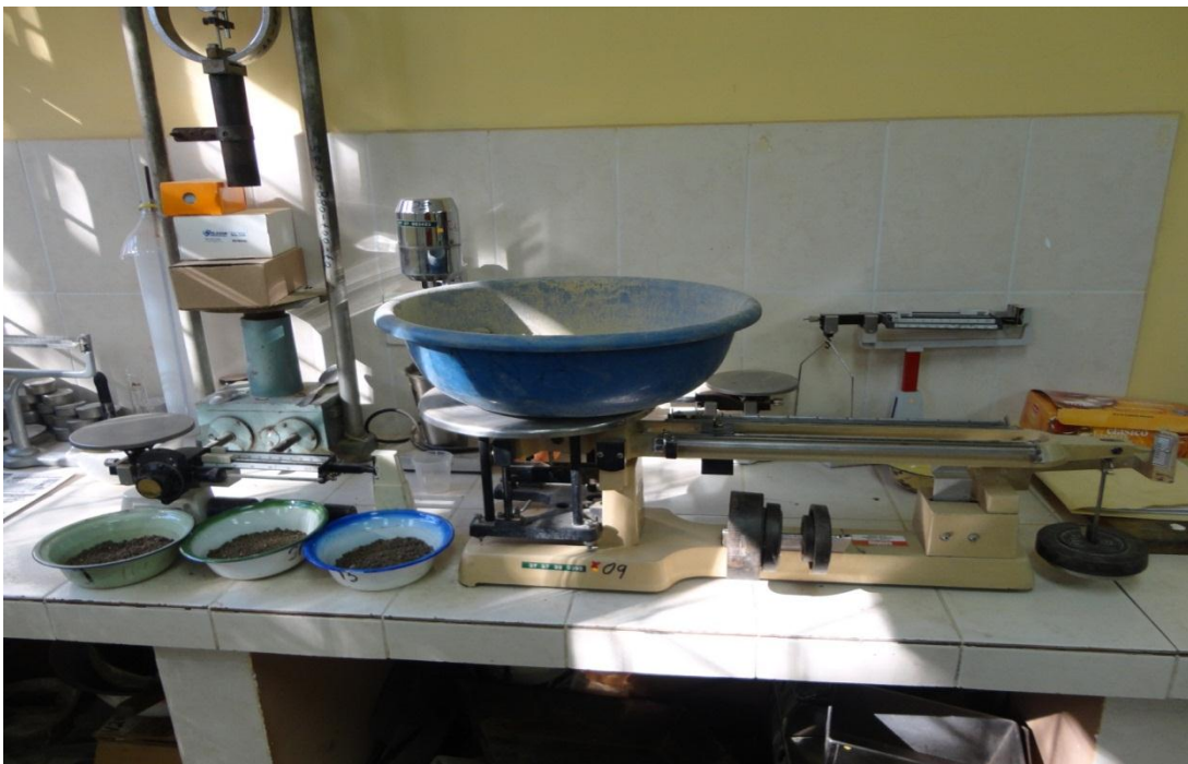
Figura 45 pesado del material retenido en el tamiz 12
