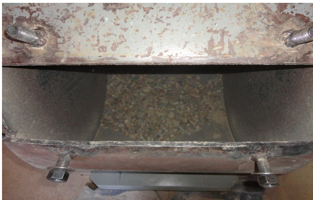
Figura 33 Muestra introducida en la máquina de los ángeles
