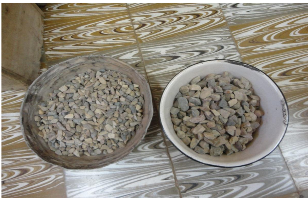
Figura 25 Preparación de la muestra para introducir a la máquina de los ángeles
