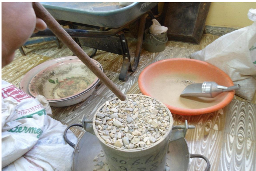
Figura 20 Llenado de la última capa en el molde
