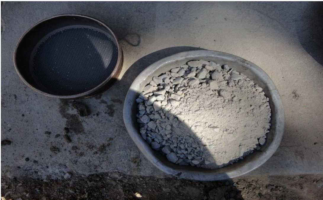
Figura 37 Material extraído de la máquina de los ángeles III
