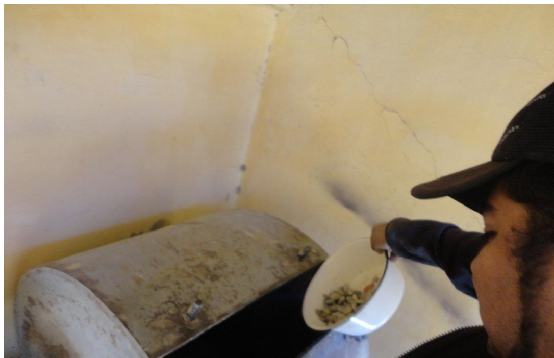
Figura 32 Introducción de las muestras a la máquina de los ángeles
