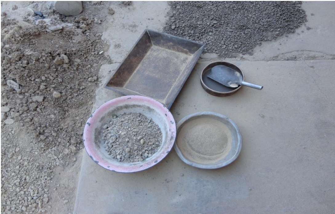
Figura 44 Muestra separada por tamiz N.- 12 IV
