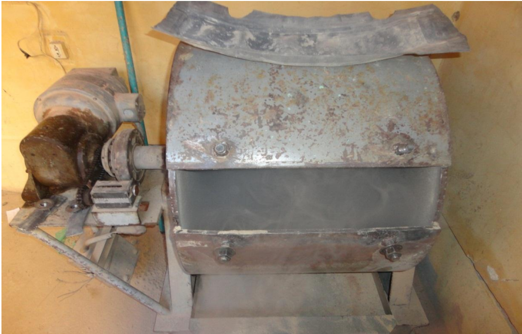
Figura 34 Luego de terminadas las revoluciones en la máquina de los ángeles se procede a su destapado para extraer el material ensayado
