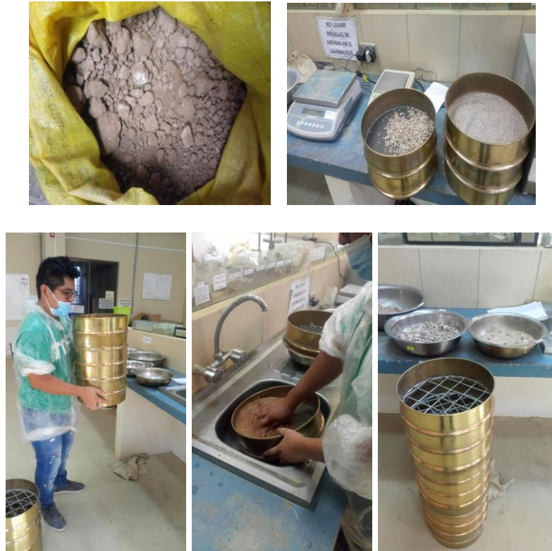
Figura 23. Esquema de la práctica de granulometría
