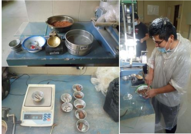
Figura 24. Materiales y realización de límite líquido y límite plástico
