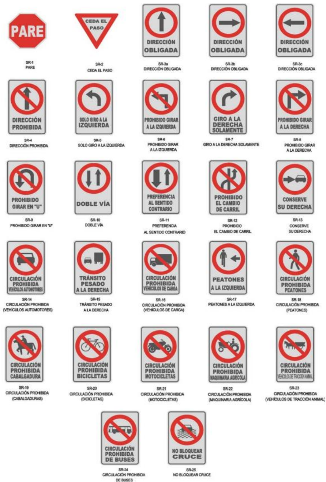
Figura N ° 2.12. Señales reglamentarias 1-25
