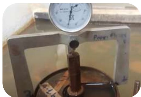
Medición de la expansión.
