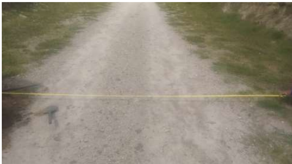
Figura 3.2.3.2 Medición del ancho del tramo.
