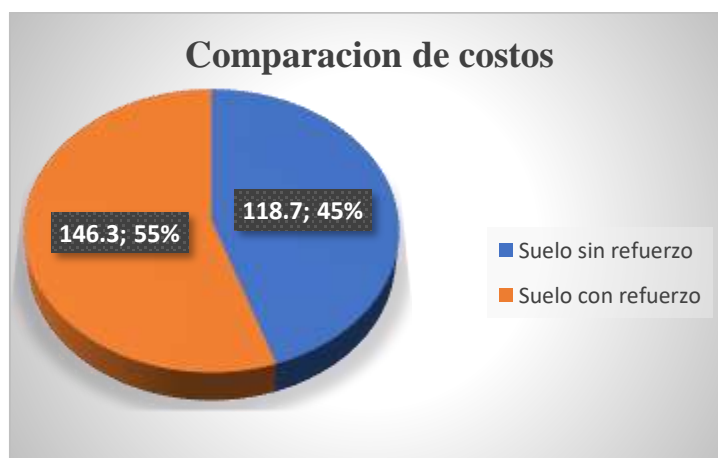
Figura 3.8.2.3.3 Comparación de costos tramo 3 geosintético tipo 2.
