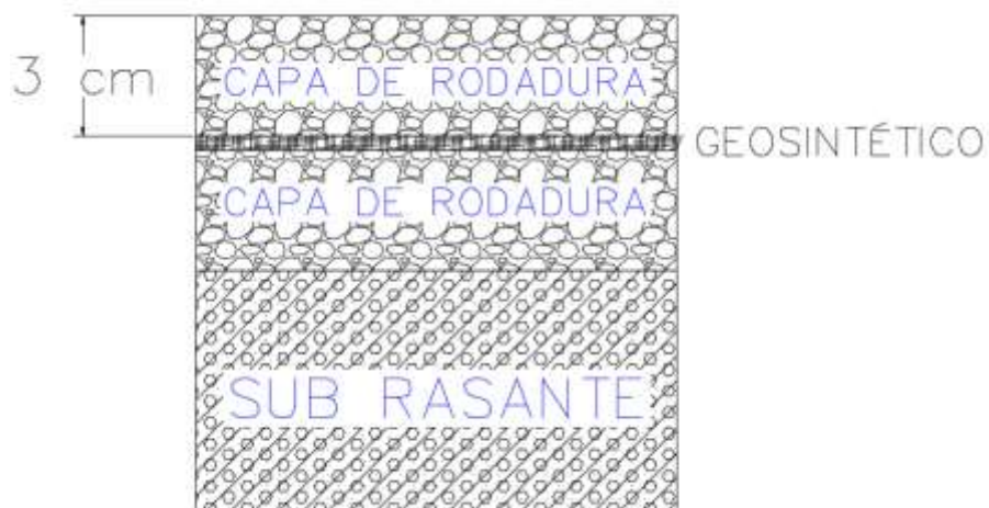
Figura 3.6.4.3 Tercera combinación con geosintético.
