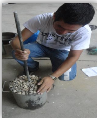
Fig. 4-9. Apisonando la muestra (grava)
