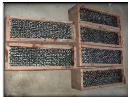
Fig. 4-54. Seis vigas con geocompuesto
