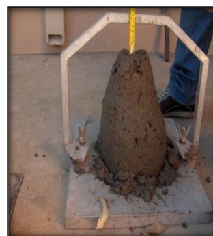
Fig. 4-33. Medición del asentamiento
