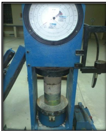
Fig. 4-73. Aplicación de la carga en probetas con geosintético
