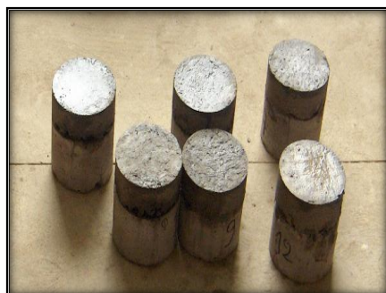
Fig. 4-61. Probetas circulares desmoldadas
