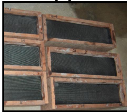
Fig. 4-52. Seis vigas con geogrilla.
