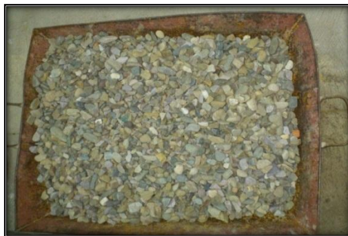
Fig. 4-1. Agregado grueso Grava
