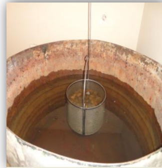
Fig. 4-8. Peso de la grava en el agua
