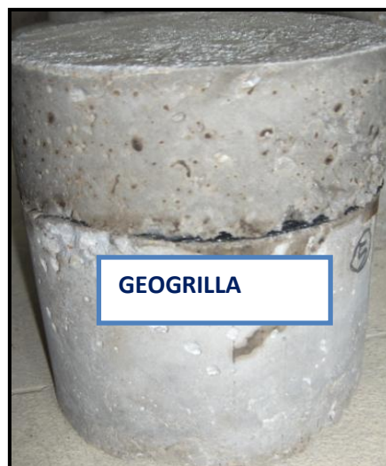
Fig. 4-67. Recapamiento de hormigón con Geogrilla en probetas
