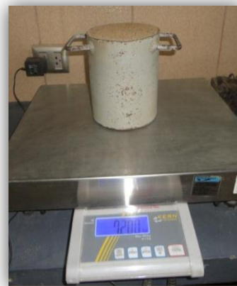
Fig. 4-20. Peso del molde con la arena
