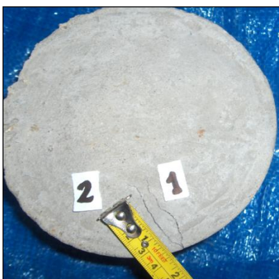
Fig. 4-41. Midiendo la fisura en la probeta circular
