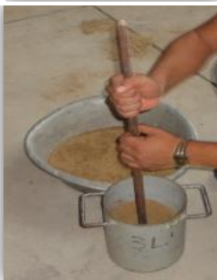
Fig. 4-19. Apisonado la muestra (arena)
