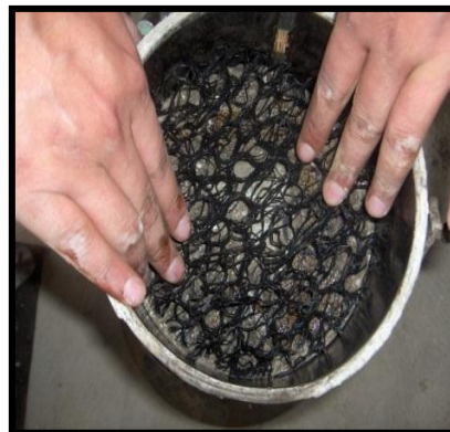
Fig. 4-46. Verificando el tamaño del geocompuesto en las probetas
