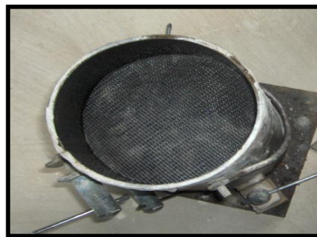
Fig. 4-58. Probeta circular de geogrilla con desencofrante
