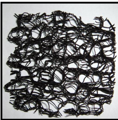
Fig. 4-27. Geocompuesto utilizado como anti-reflejos de fisuras
