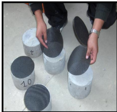
Fig. 4-45. Midiendo la geogrilla a las probetas circulares
