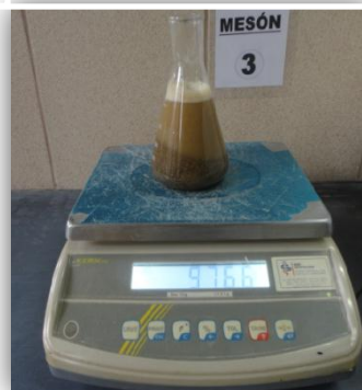
Fig. 4-17. Pesando la arena más el agua y matraz
