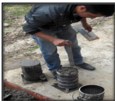
Fig. 4-59. Apisonando y nivelando el concreto en las probetas circulares.
