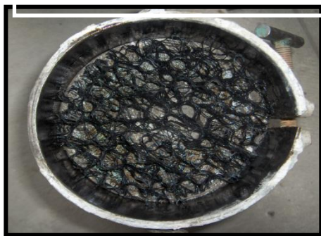
Fig. 4-57. Probeta circular de geocompuesto con desencofrante
