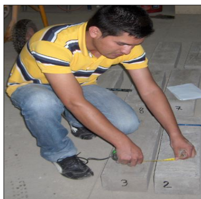
Fig. 4-42. Midiendo la fisura en la viga
