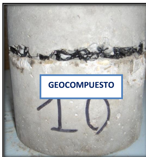
Fig. 4-68. Recapamiento de hormigón con Geocompuesto en probetas
