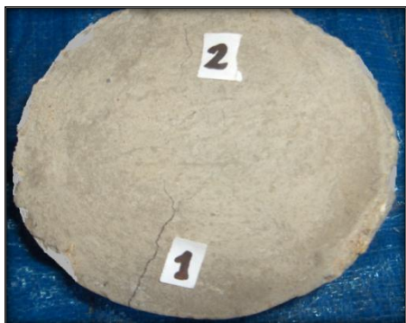
Fig. 4-69. Fisuras en la carpeta antigua
