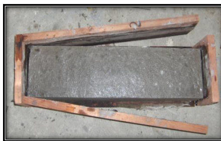
Fig. 4-40. Desmoldando las vigas
