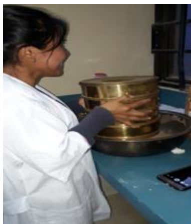
Figura 3.14-3.15 Tamizado manual y pesaje de material retenido en cada malla.
