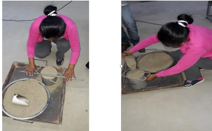
Figura 3.56-3.57 Llenado del agregado suelto y varillado.
