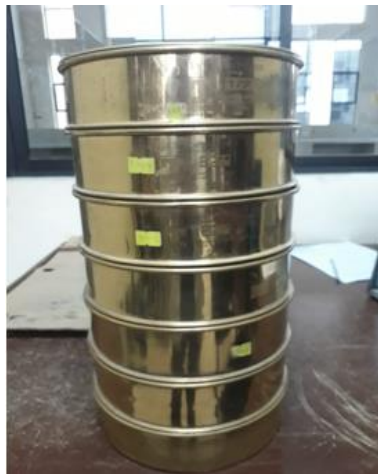
Figura 3.12-3.13 Juego de tamices y pesaje de la muestra.
