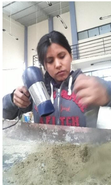
Figura 3.44 Secado de muestra superficialmente.
