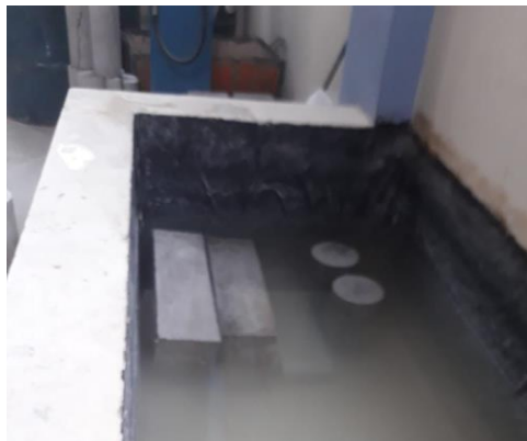
Figura 3.77 Curado de vigas.
