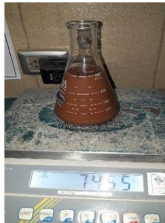
Figura 3.9-3.10 Frasco volumétrico + suelo a baño maría + suelo.
