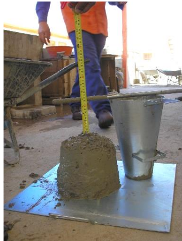
Figura 2.6 Prueba de asentamiento con el cono de Abrams.
