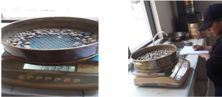
Figura 3.37-3.38 Registro de peso retenido en cada tamiz.
