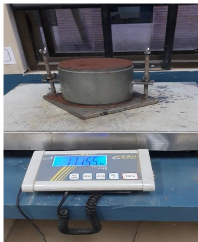
Figura 3.27 Peso de suelo compactado más molde.
