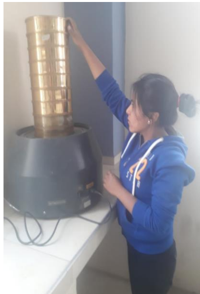
Figura 3.40: Tamizado mecánico (Rop-tap) del agregado fino.
