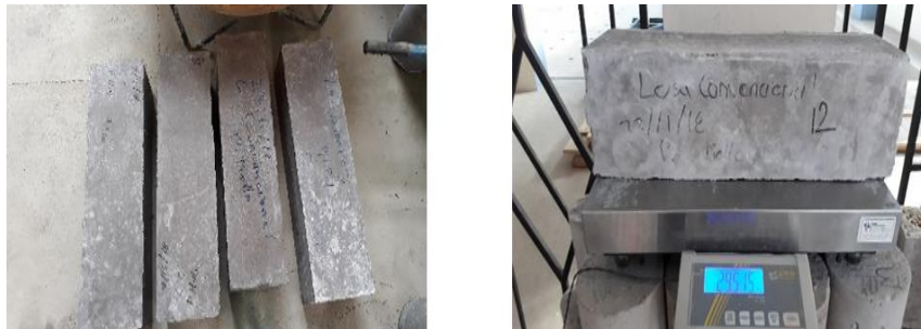
Figura 3.82-3.83 Medición y pesaje de las vigas San Blas.
