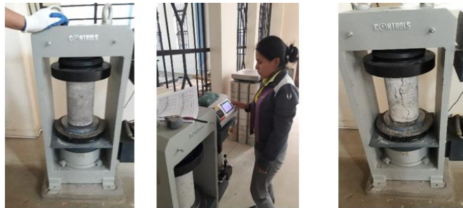
Figura 3.79: Rotura de probetas.
