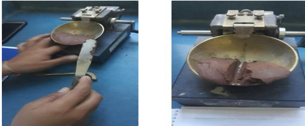
Figura 3.18-3.19 Colocación del suelo en la copa de casagrande.
