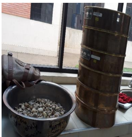
Figura 3.35-3.36 Tamizado mecánico (Rop-Tap) por la serie de tamices del agregado grueso.
