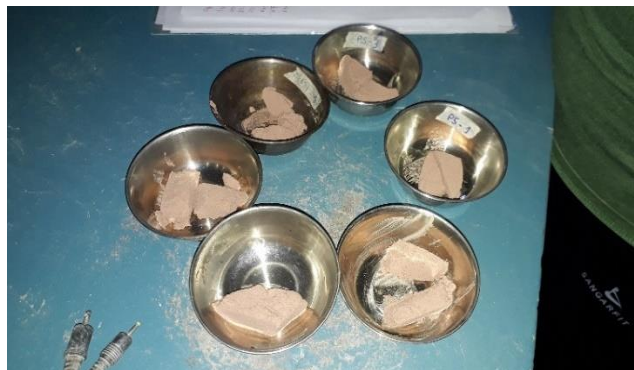
Figura 3.21 Peso del suelo secado al horno.
