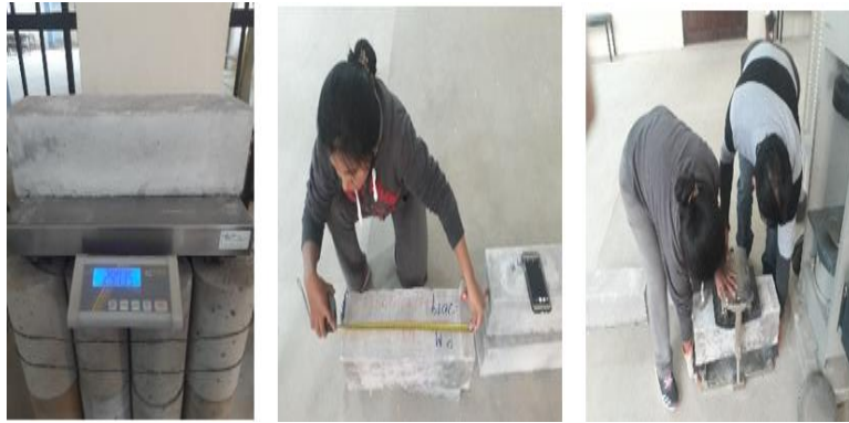
Figura 3.86-3.87 Medición y pesaje de las vigas Charajas.
