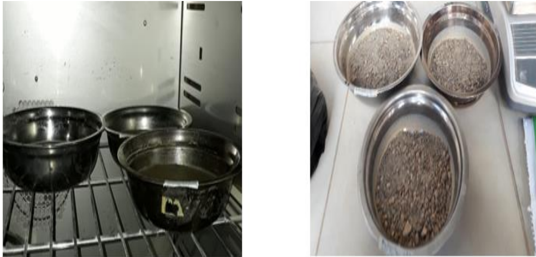
Figura 3.49-3.50 Secado en horno del agregado fino.
