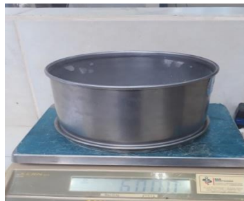
Figura 3.67 Peso retenido en el tamiz N° 200.
