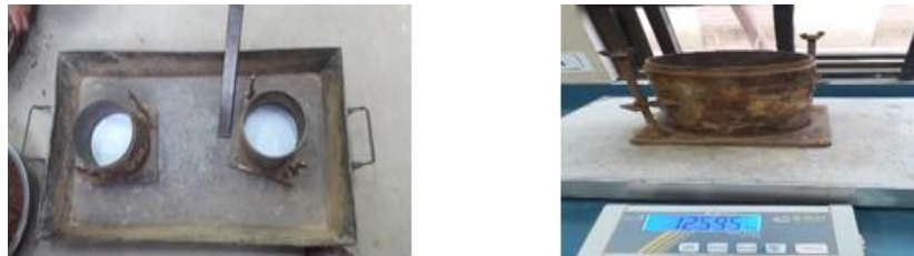
Figura 3.28 – 3.29 Peso de molde y preparación de los moldes.
