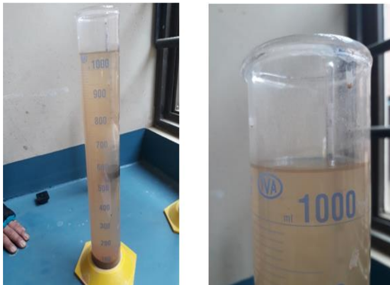
Figura 3.16-3.17 Lectura del hidrómetro + suelo.
