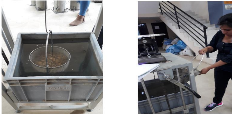
Figura 3.42 Pesaje del agregado grueso sumergido.
