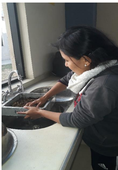
Figura 3.61 Lavado del material retenido en el tamiz N°12.
