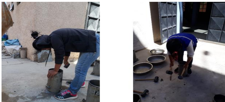
Figura 3.69-3.70 Llenado de hormigón varillado y vibrado.
