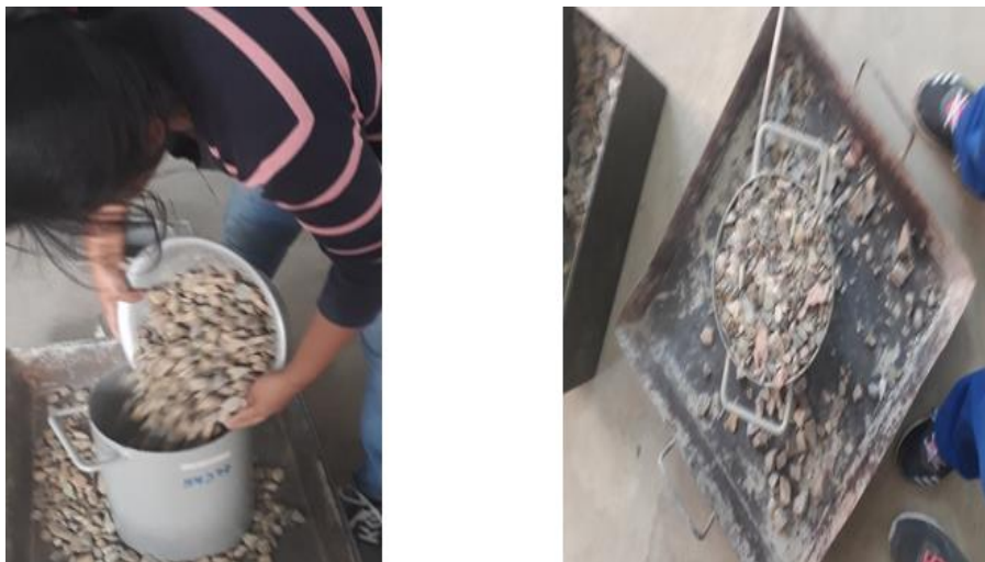
Figura 3.51-3.52 Llenado del molde con el agregado.
