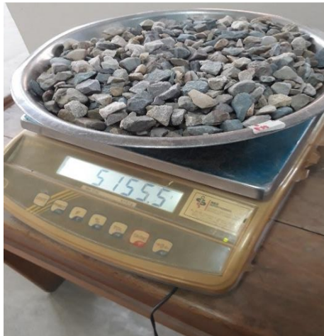
Figura 3.43 Pesaje de la muestra seca.
