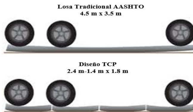
Figura 2.20 Comparación del pavimento tradicional y losas cortas.
