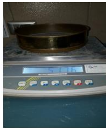
Figura 3.14-3.15 Tamizado manual y pesaje de material retenido en cada malla.
