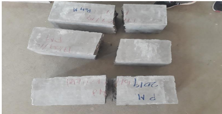
Figura 3.89 Rotura de vigas.
