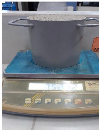
Figura 3.58 Peso del agregado suelto y varillado más el molde.
