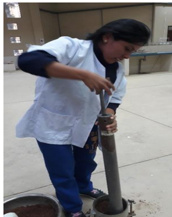
Figura 3.30: Compactación del suelo en 5 capas a 12, 25 y 56 golpes.
