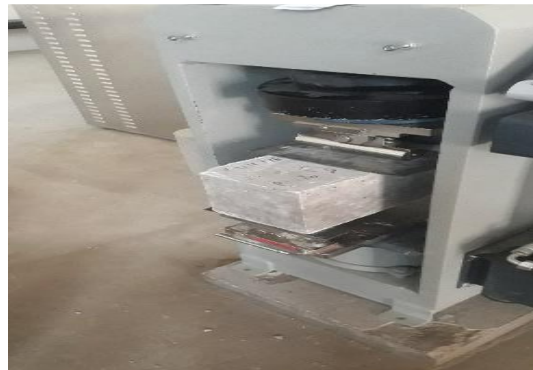
Figura 3.84 Colocado de vigas en el equipo.
