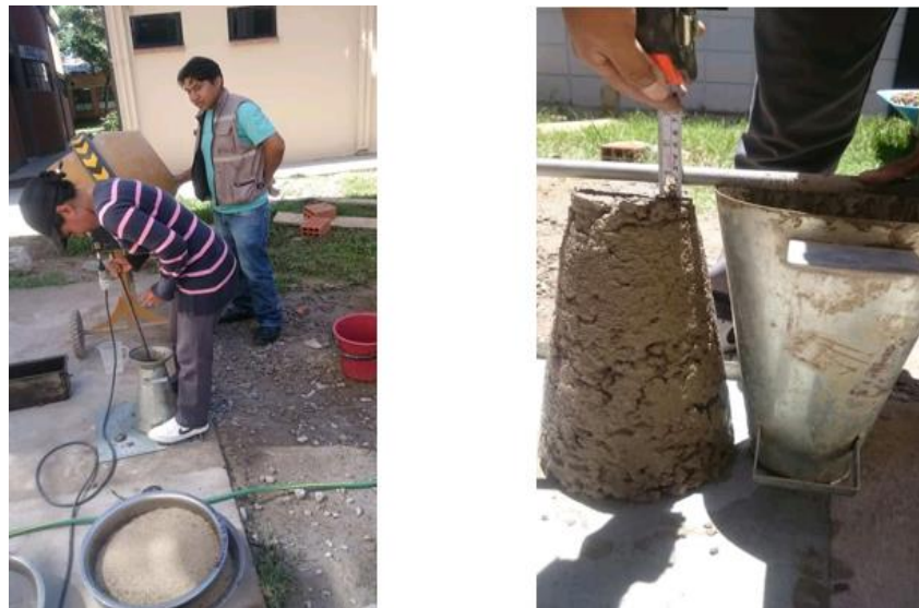
Figura 3.68 Realización del asentamiento y medición.
