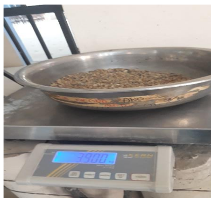
Figura 3.62 Peso de material secado al horno.
