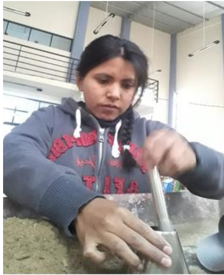
Figura 3.45-3.46 Verificación de la condición muestra saturada con superficie seca.
