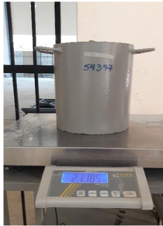
Figura 3.55 Peso del agregado suelto y varillado más el molde.
