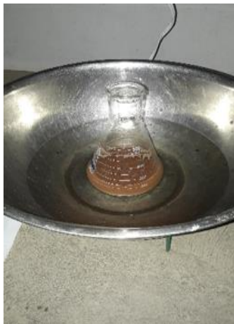
Figura 3.9-3.10 Frasco volumétrico + suelo a baño maría + suelo.
