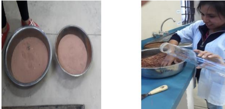
Figura 3.23 - 3.24 Pesaje del suelo y colocado de fracción de agua al suelo.
