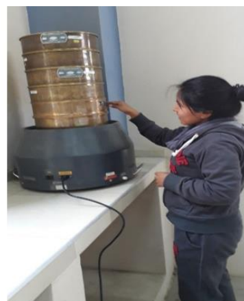
Figura 3.35-3.36 Tamizado mecánico (Rop-Tap) por la serie de tamices del agregado grueso.
