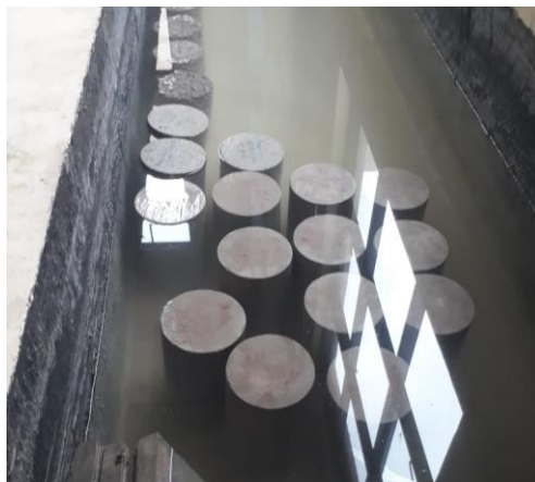
Figura 3.75 Curado de las probetas.
