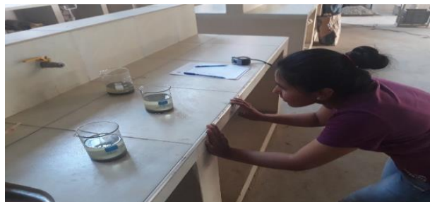
Figura 3.64 Lectura del volumen desplazado.
