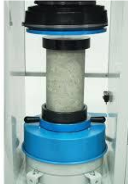
Figura 1.2. Rotura a compresión de probetas
