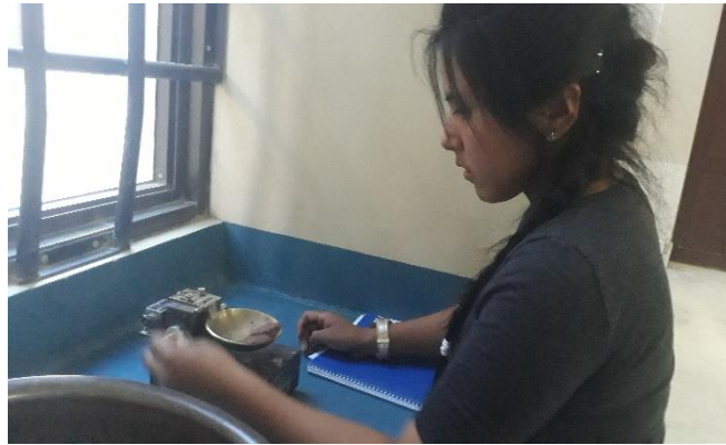
Figura 3.20 Realización del límite líquido.
