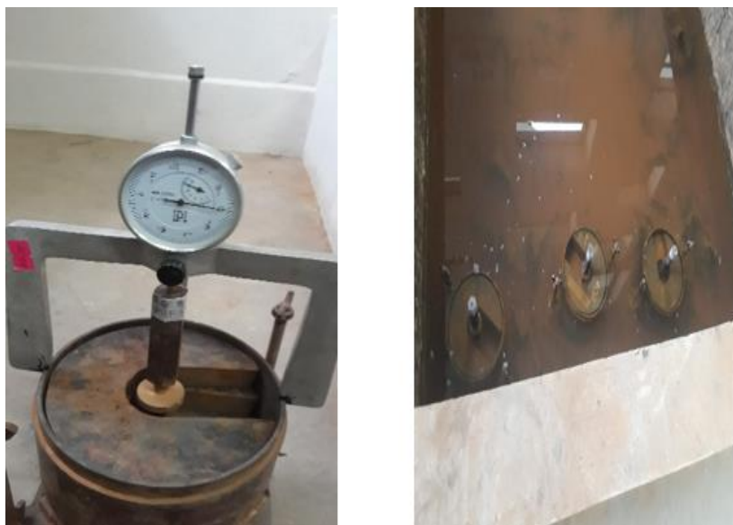
Figura 3.31 – 3.32 Saturación de los moldes C.B.R en agua.
