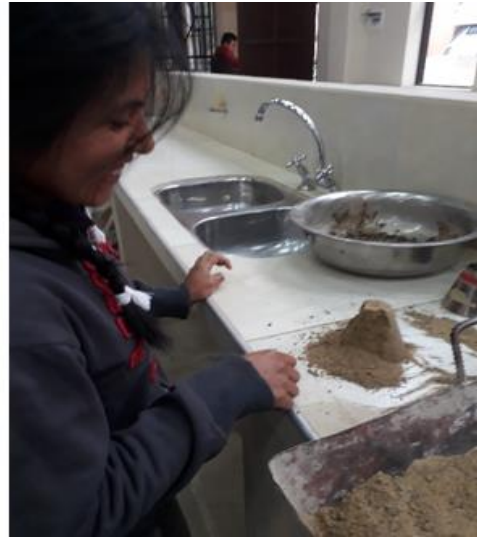
Figura 3.45-3.46 Verificación de la condición muestra saturada con superficie seca.
