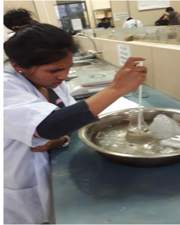
Figura 3.8 Frasco volumétrico a baño maría frío para el descenso de temperaturas.
