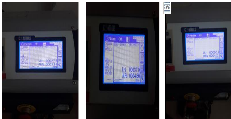
Figura 3.88 Resultados de la rotura de vigas.
