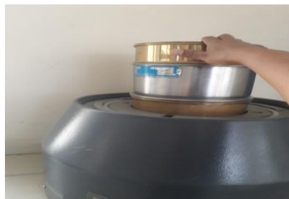
Figura 3.66 Tamizado mecánico (Rop-tap).
