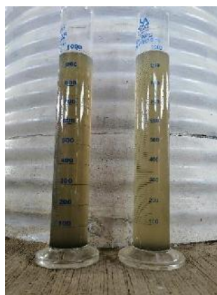
Figura 5. 16. Muestra de sedimentación del lodo en el tanque aeróbico y tanque SBR
