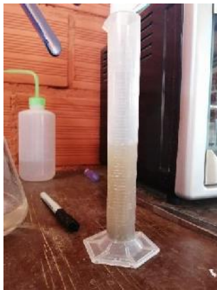
Figura 5. 24. Recogida de la muestra en probeta de 50 ml
