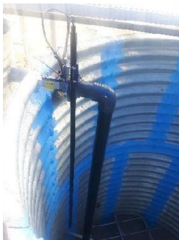
Figura 4. 53. Medidor de Oxígeno Disuelto
