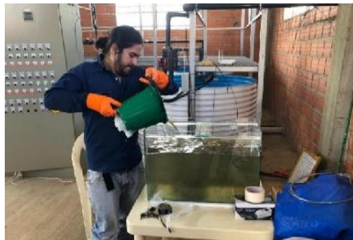
Figura 5. 6. Insertando el aporte de las aguas residuales hacia la PTAR del barrio Catedral
