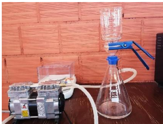
Figura 5. 25. Vertido de la Muestra en un juego de matraz.
