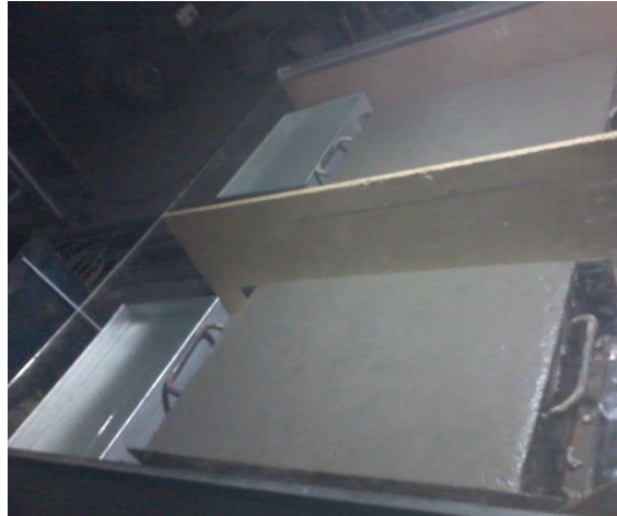
Figura 60 Paneles de hormigón en la cámara ambientada
