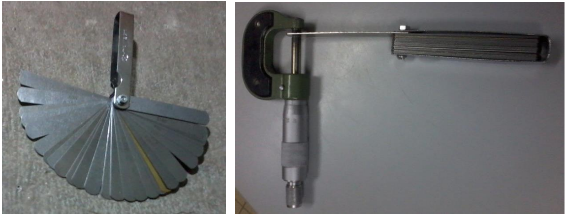
Figura 56 Juego de galgas metálicas
