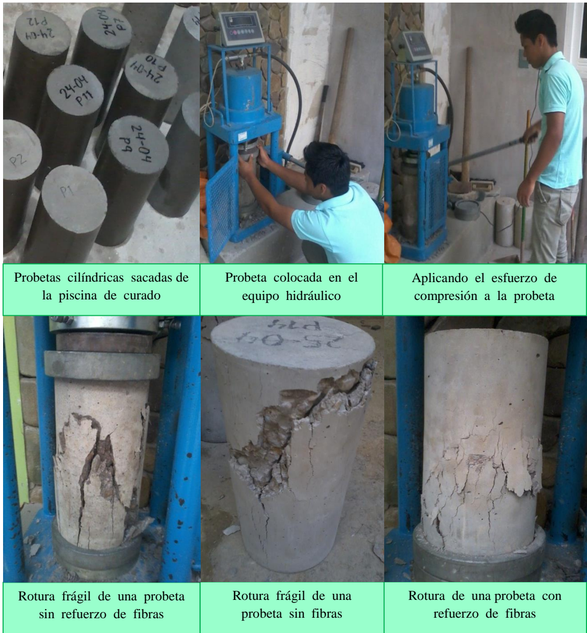
Figura 48 Ensayo de resistencia a compresión
