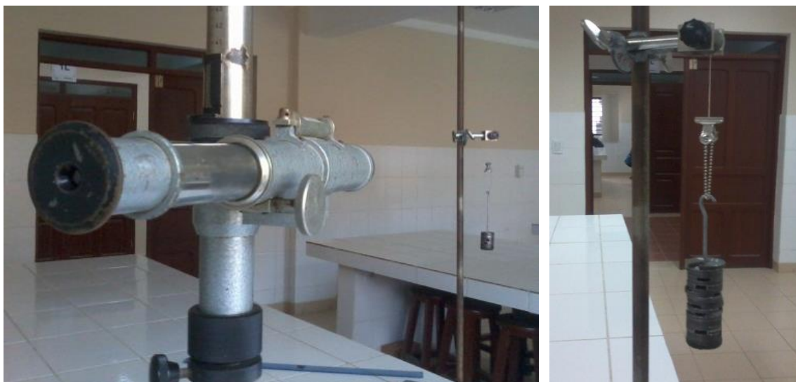
Figura 36 Ensayo de resistencia a tracción
