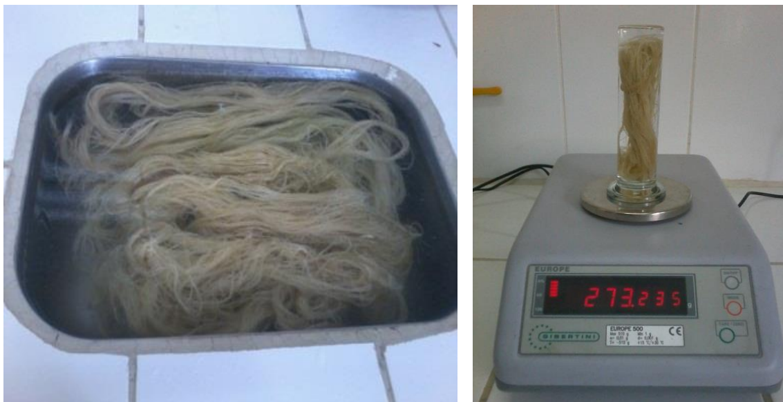
Figura 39 Ensayo de densidad de las fibras de Caraguata
