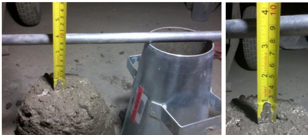
Figura 46 Medición del asentamiento en el hormigón
