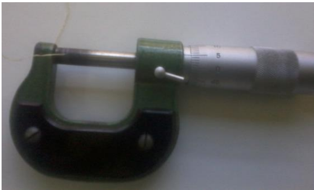
Figura 35 Medición del diámetro de una fibra de Caraguata
