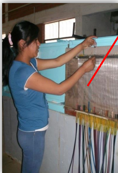
INSTALACIÓN TABLERO PIEZOMÉTRICO
