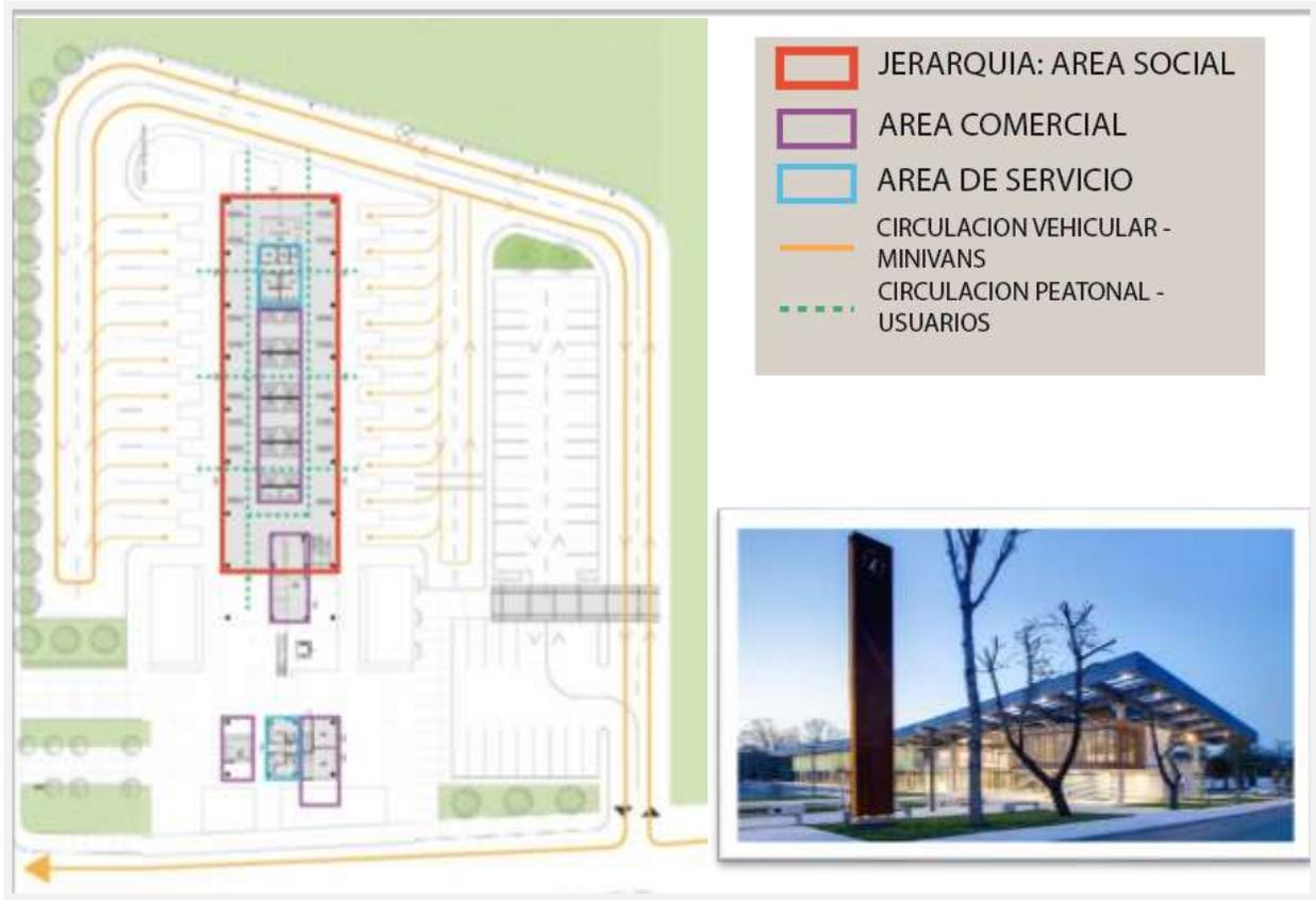
Figura N° 33 esquema funcional de terminal Lüleburgaz,
