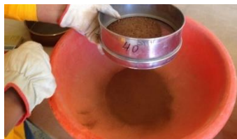
Fotografía 3. 18 Material para ensayo de límites
