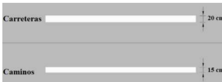
Figura 2.8 Dimensiones de demarcación continua
