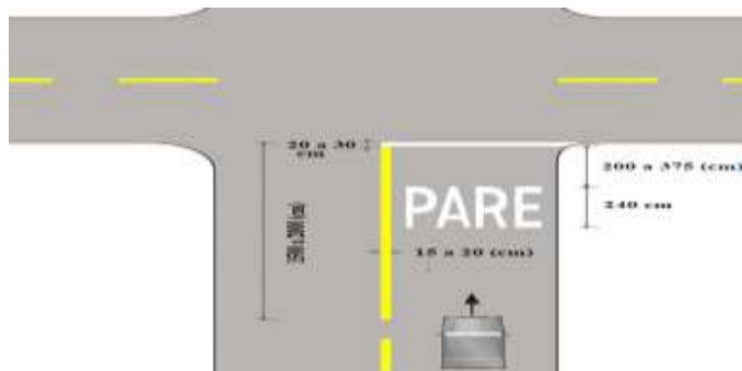
Figura 2.11 Señalización horizontal en cruce reglado con la señal pare
