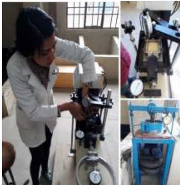
Figura 39. Equipos de consolidación.
