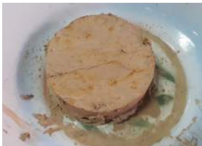
Figura 43. Muestra seca retirada de horno a 110° C
