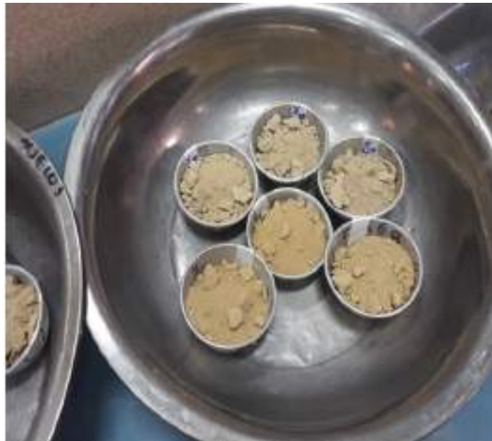
Figura 33. Ensayo de contenido de humedad
