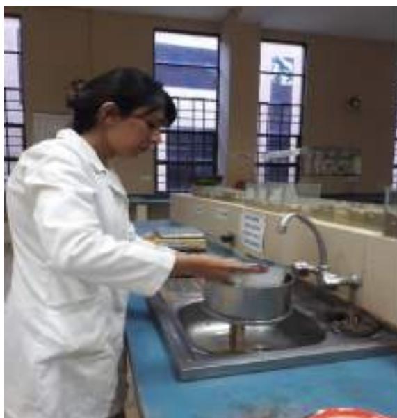
Figura 35. Ensayo de granulometría por el método de lavado
