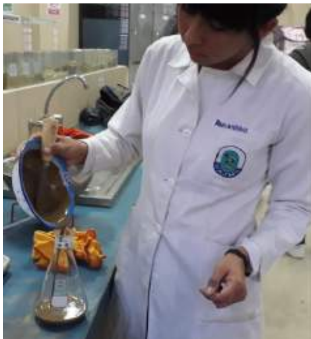
Figura 34. Ensayo peso específico
