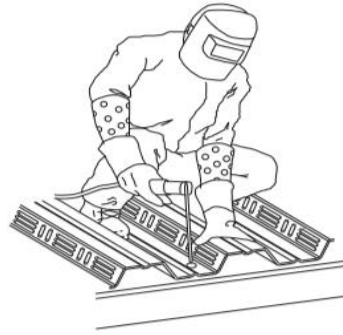
Fijación con soldadura
