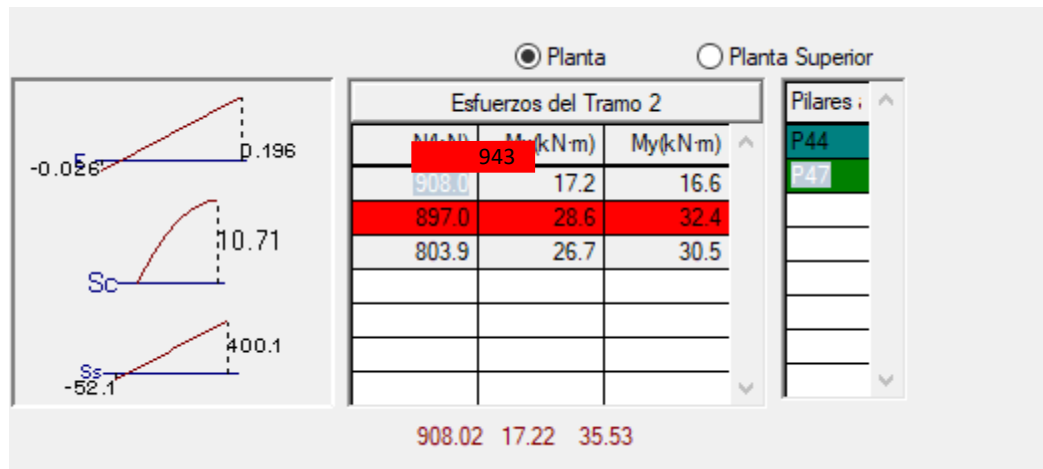
Figura 3.6: Esfuerzos de diseño de la columna P47 (Fuente: CYPECAD 2017)
