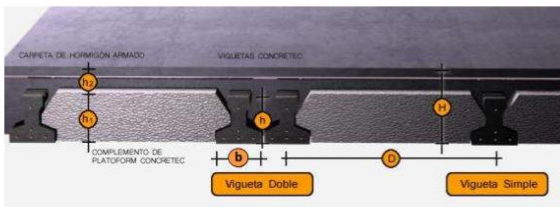
Figura 3.4. Sistema de aplicación de la viga (Fuente CONCRETEC)
