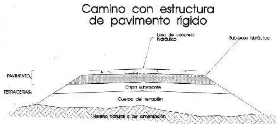
Figura 2.2.- Camino con estructura de pavimento rígido
