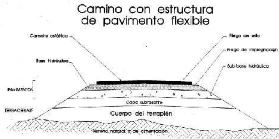
Figura 2.1.- Camino con estructura de pavimento flexible
