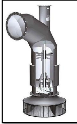
Figura 3.11 a) Bomba axial b) Corte esquemático de una bomba axial
