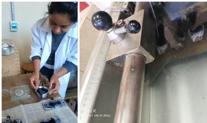
Imagen 3-14 Determinación de la ductilidad del asfalto
