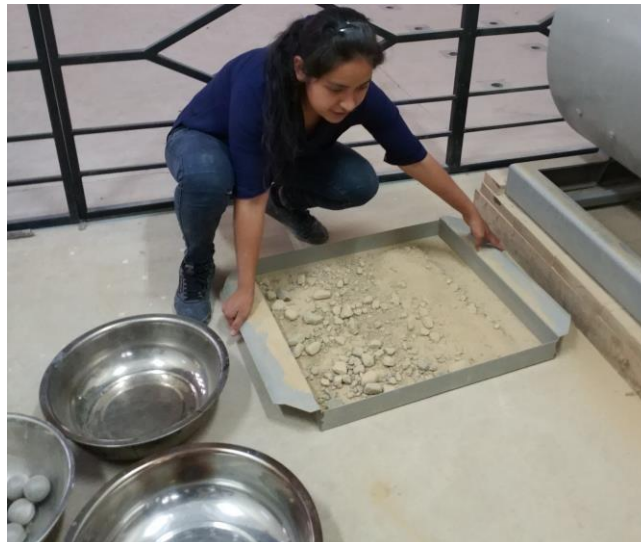
Imagen 3-22 Muestra triturada con el ensayo de la máquina de los Ángeles
