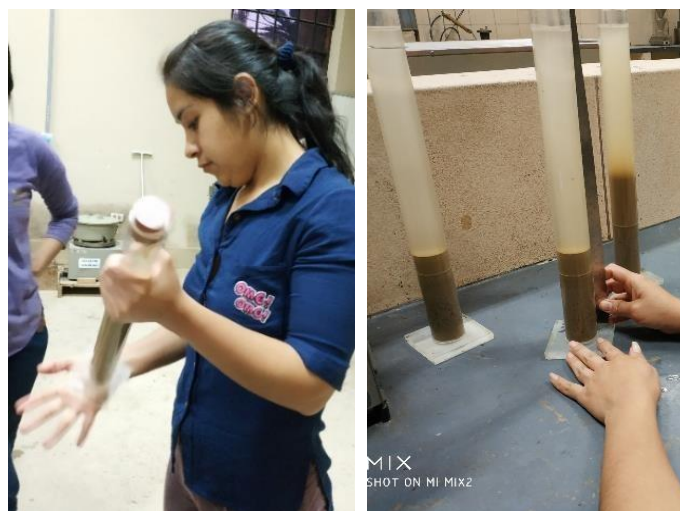
Imagen 3-11 Determinación de equivalente de arena
