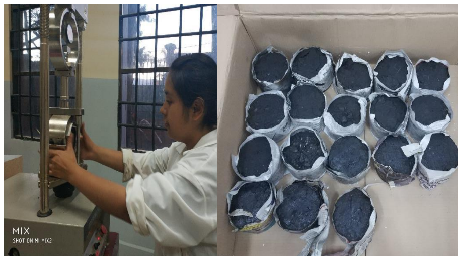
Imagen 4-2 Lectura de fluencia de las briquetas de mezcla asfáltica
