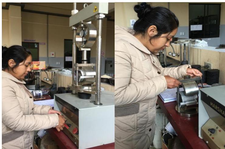
Imagen 3-27 Lectura de estabilidad de los núcleos extraídos
