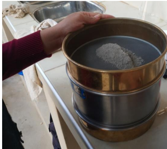
Imagen 3-23 Tamizado de la muestra para la finura del cemento
