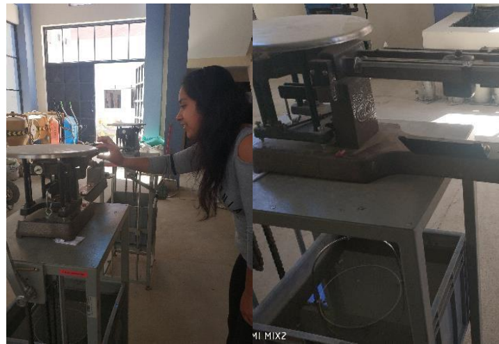
Imagen 3-8 Peso específico del agregado grueso
