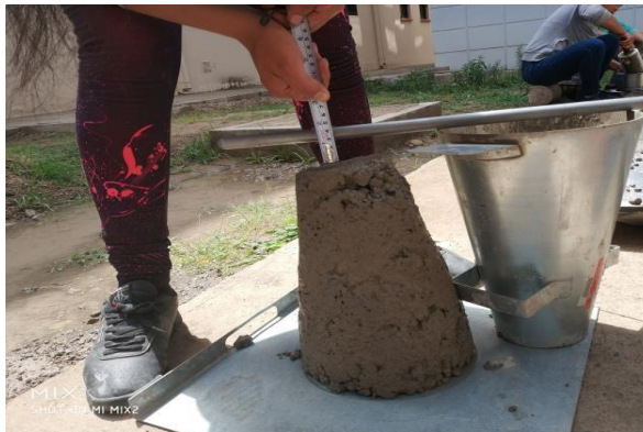
Imagen 4-5 Lectura del asentamiento de la mezcla
