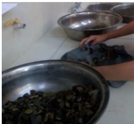
Imagen 3-18 Secado superficial de la grava
