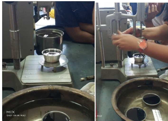
Imagen 3-12 Ensayo de penetración del asfalto
