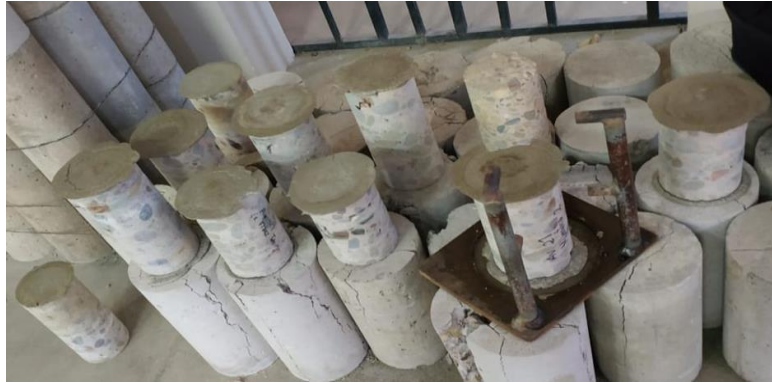
Imagen 3-29 Proceso de rotura de los testigos de pavimento rígido extraídos de los tramos
