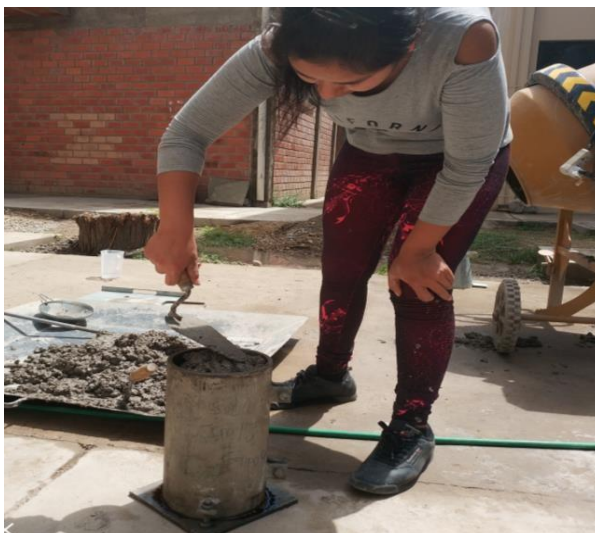
Imagen 4-4 Vaciado la mezcla de hormigón
