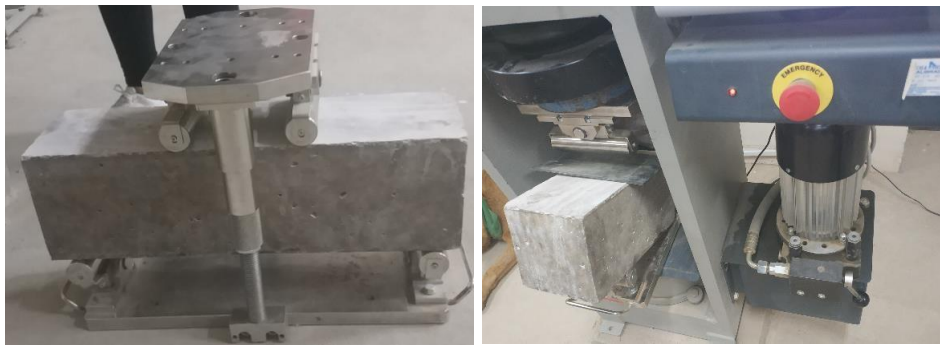
Imagen 4-7 Rotura de una viga de concreto
