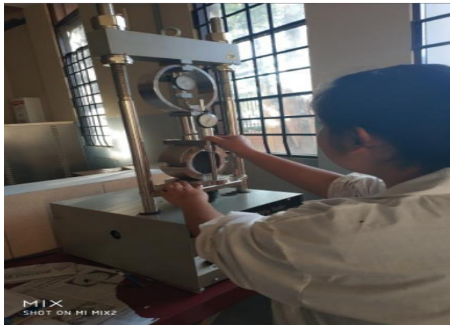
Imagen 2-3 Máquina de estabilidad y fluencia de Marshall
