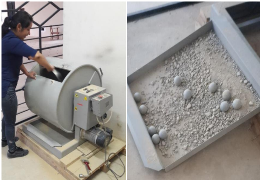
Imagen 3-10 Colocación de la muestra en la máquina de los Ángeles
