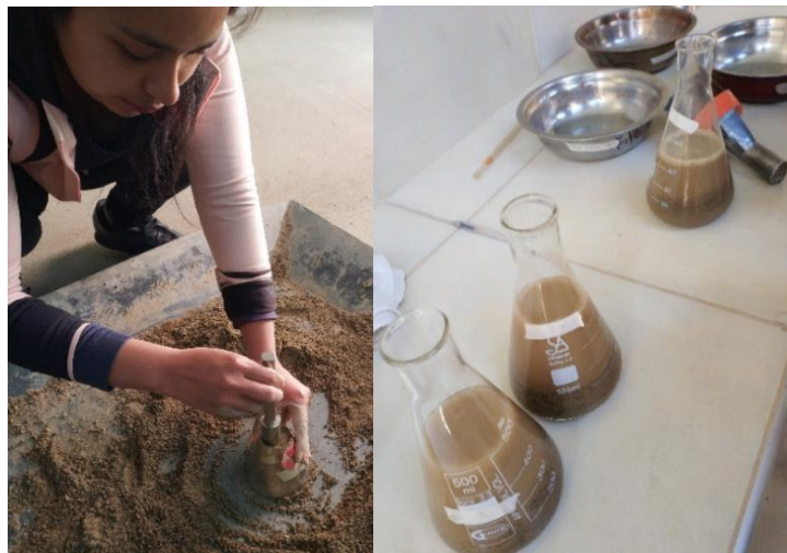
Imagen 3-9 Determinación del peso específico de la arena
