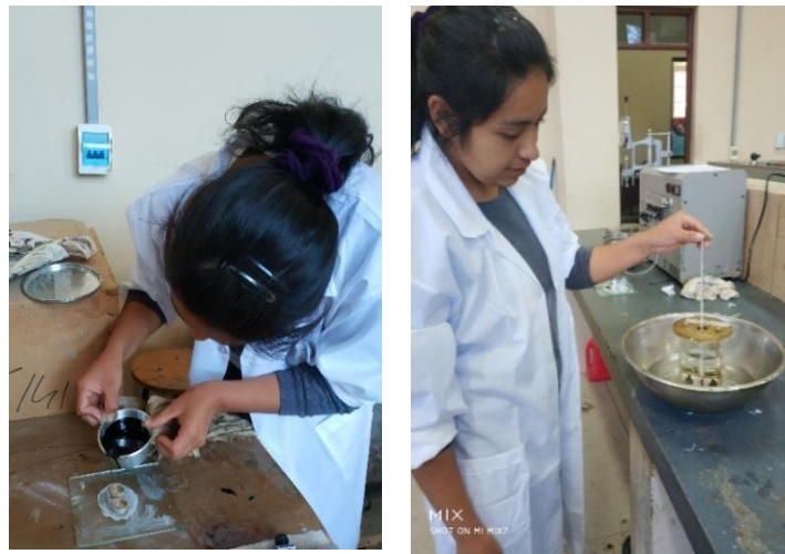
Imagen 3-15 Punto de ablandamiento del asfalto
