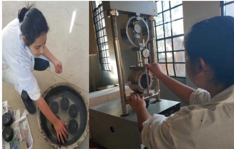
Imagen 4-1 Colocación de las briquetas asfálticas en un baño a 60 °C y lectura
