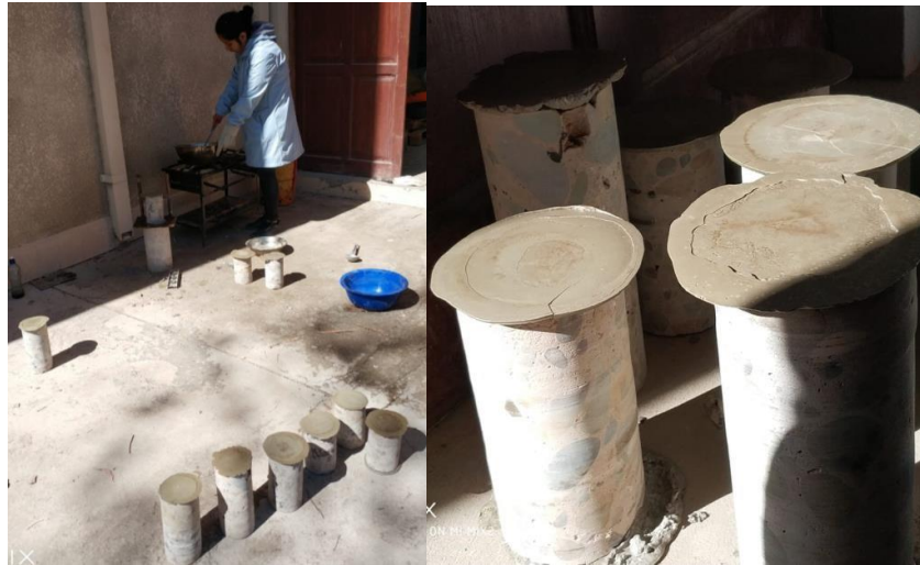
Imagen 3-28 Recapinación de los testigos de pavimentos rígidos
