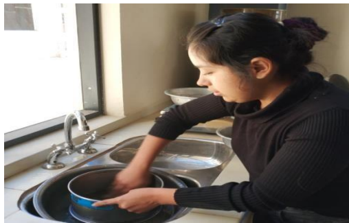
Imagen 3-17 Lavado de la arena con tamiz N°200
