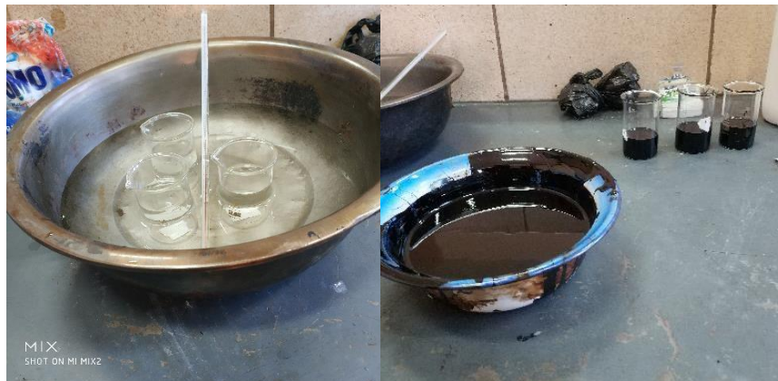
Imagen 3-16 Determinación del peso específico del cemento asfáltico
