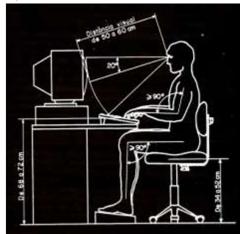
Fig.73 Medidas en corte de visión y mobiliario para funcionario Administrativo
