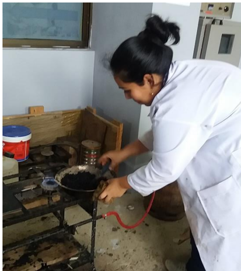
Figura N° 3.4 Mezcla de los agregado más el cemento asfáltico.
