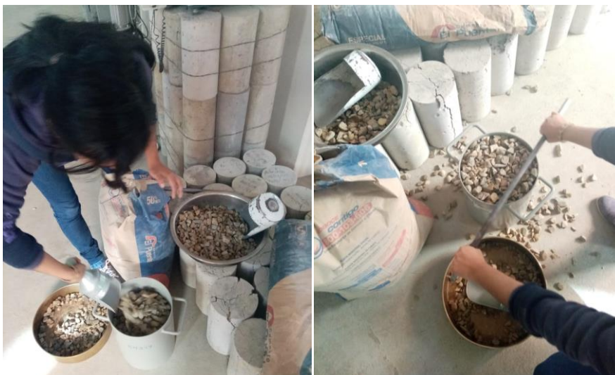
Figura 2.25 Vertido y enrasado de la grava en el molde
