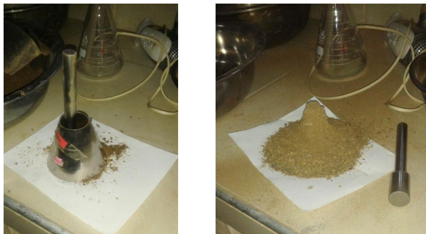
Figura 2.22 Prueba de cono para verificar si esta correctamente secado
