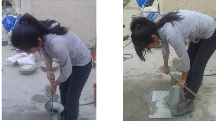
Figura 3.8 Compactado y enrasado de la mezcla en el Cono de Abrams
