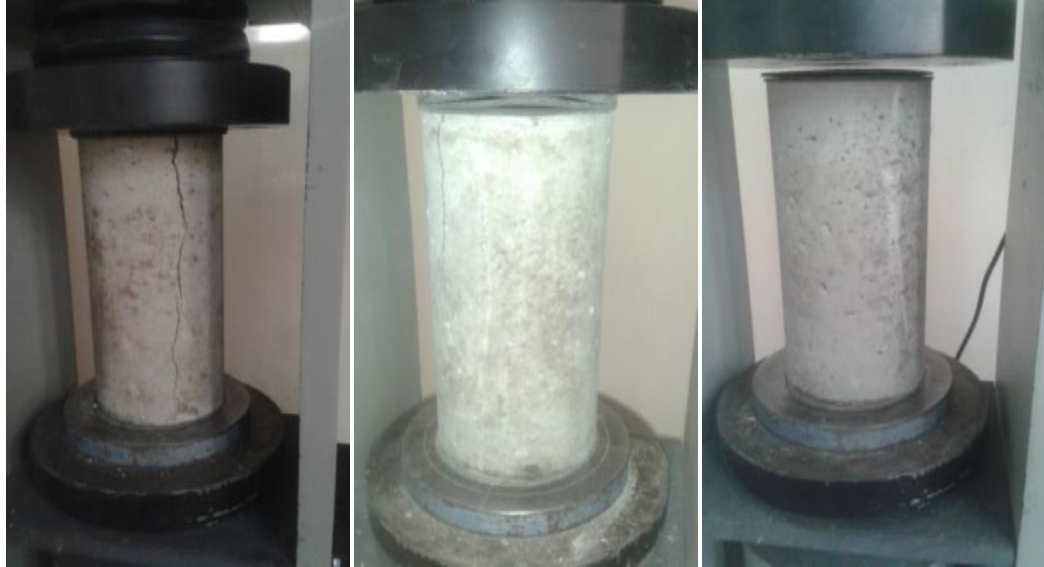
Figura 3.20 Fisuras de probetas (patrón, 10% y 15% de PET )
