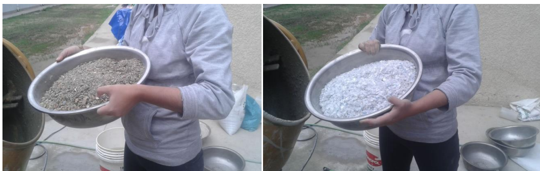
Figura 3.5 Dosificación de arena y PET
