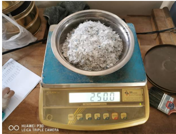
Figura 2.15 Pesada de material PET
