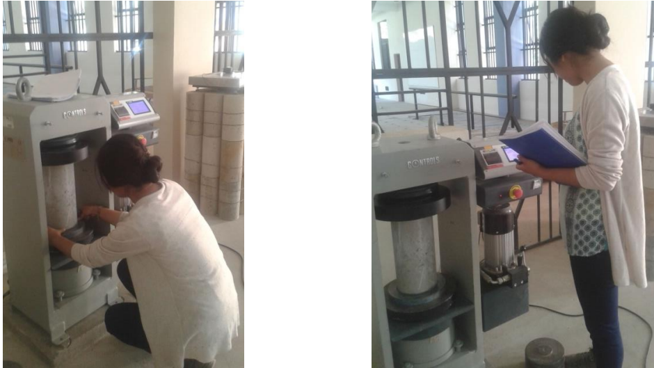
Figura 3.18 Probetas llevadas a la prensa (ensayo a compresión)
