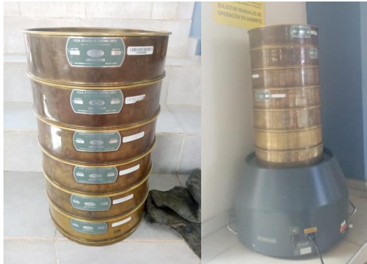
Figura 2.10 Juegos de tamice y tamizado en el vibrador mecánico
