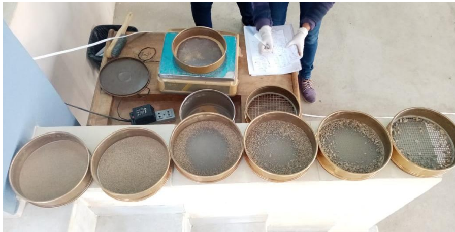
Figura 2.14 Pesada de arena retenida en cada uno de los tamices material
