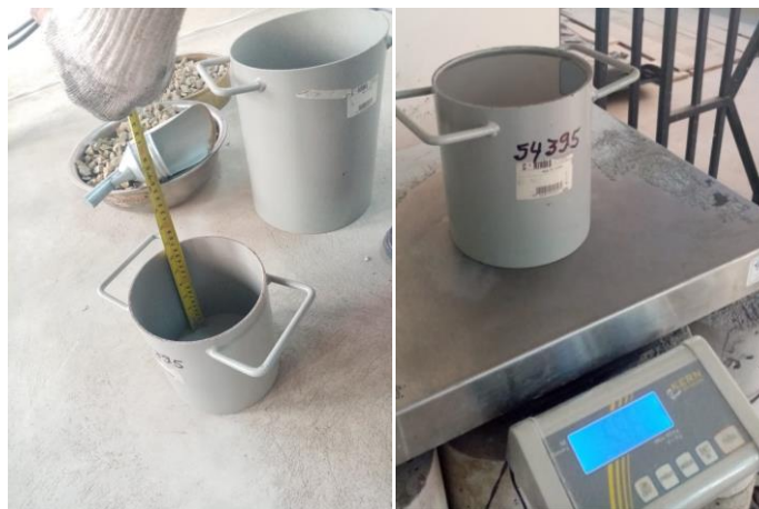
Figura 2.27 Medición y calibración del molde para la arena
