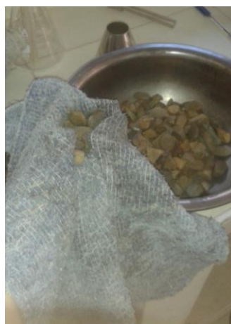
Figura 2.18 Secado superficial de la grava
