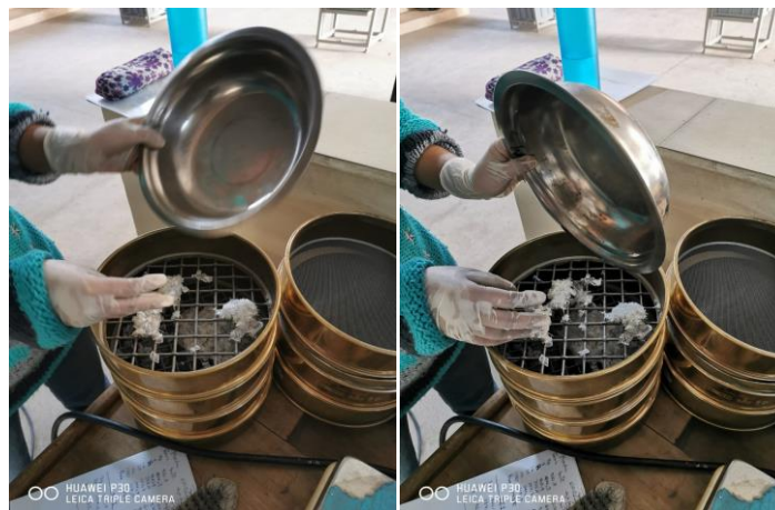
Figura 2.16 Tamizado de material PET
