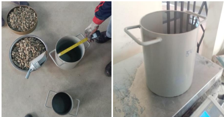
Figura 2.24 Medición y calibración del molde de agregado grueso
