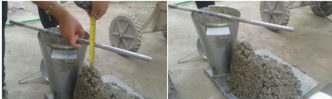
Figura 3.11 Medición de asentamiento de la mezcla al 15% y 20% de PET
