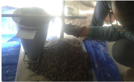
Figura 3.12 Medición del asentamiento de la mezcla al 30% de PET
