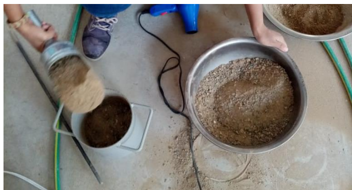
Figura 2.28 Vertido suelto de la arena en el molde
