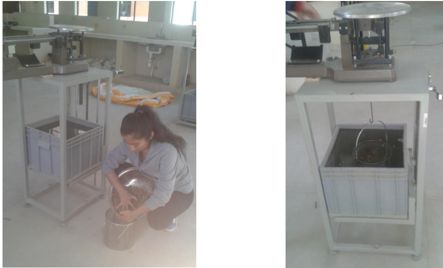
Figura 2.19 Pesada en el aparato de grava sumergida en agua
