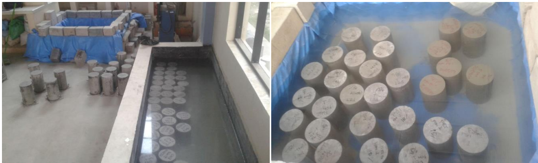
Figura 3.16 Curado de probetas en piscinas de agua
