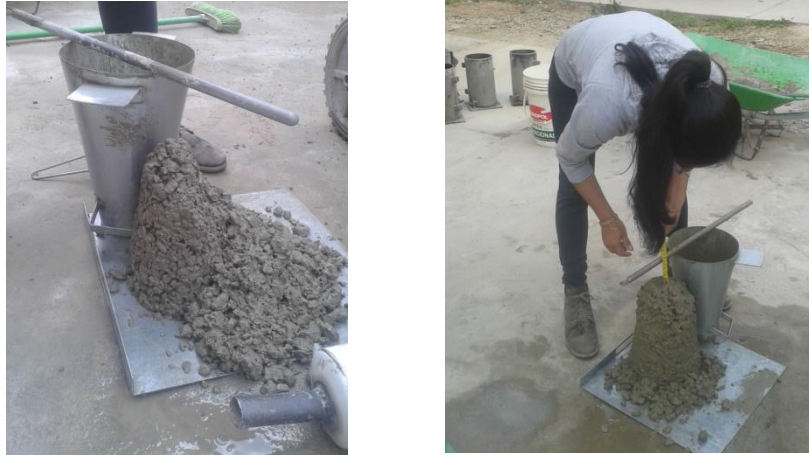
Figura 3.10 Medición del asentamiento de la mezcla patrón y 10% de PET
