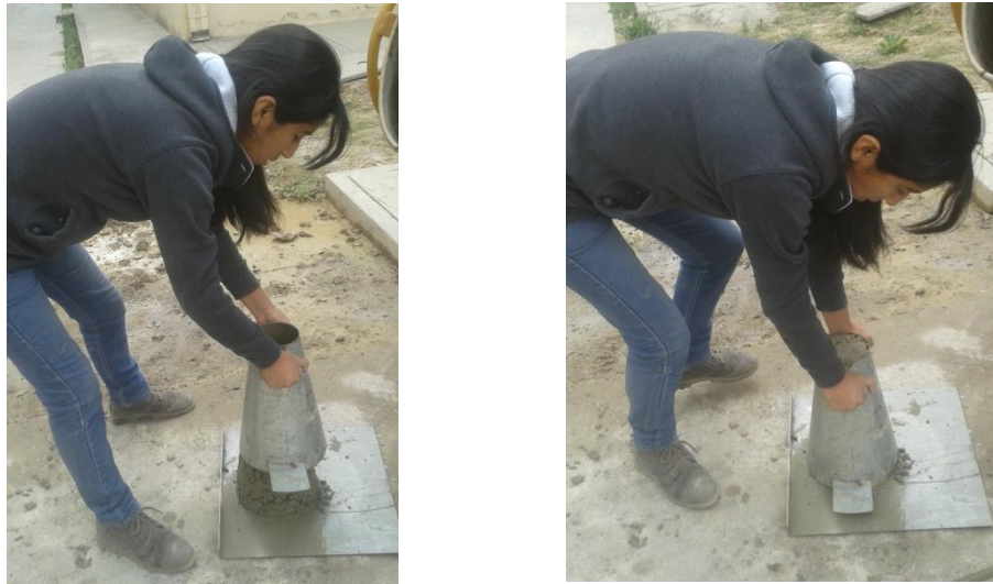
Figura 3.9 Ensayo del Cono de Abrams
