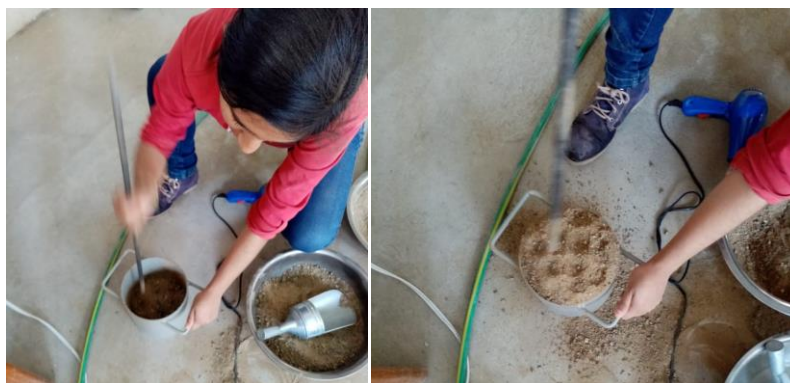
Figura 2.29 Compactado y enrasado de la arena
