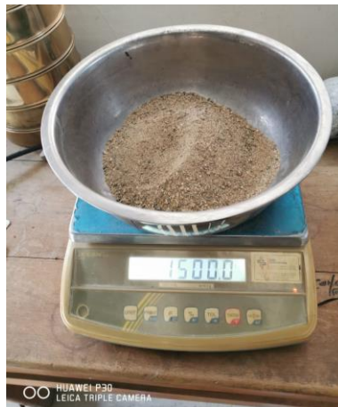
Figura 2.20 Pesada de arena a saturar por 24 hrs
