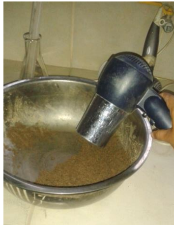
Figura 2.21 Secado superficial de la arena
