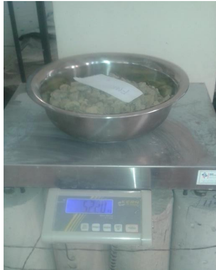
Figura 2.17 Grava saturada con agua por 24 hrs
