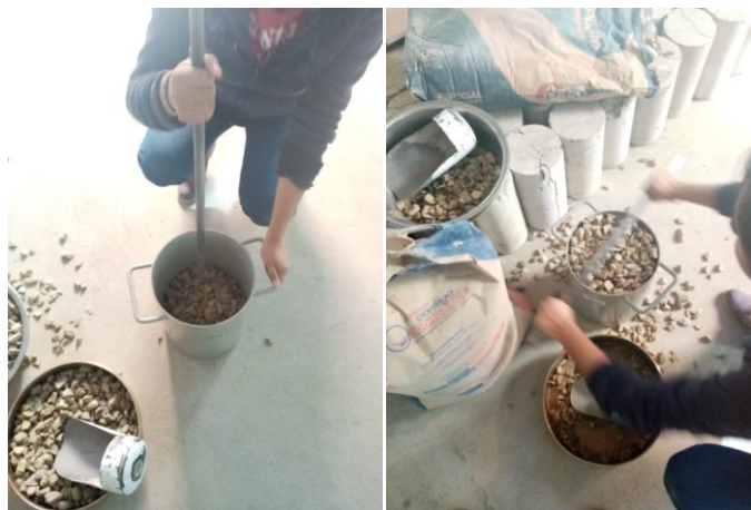
Figura 2.26 Compactado y enrasado de la arena
