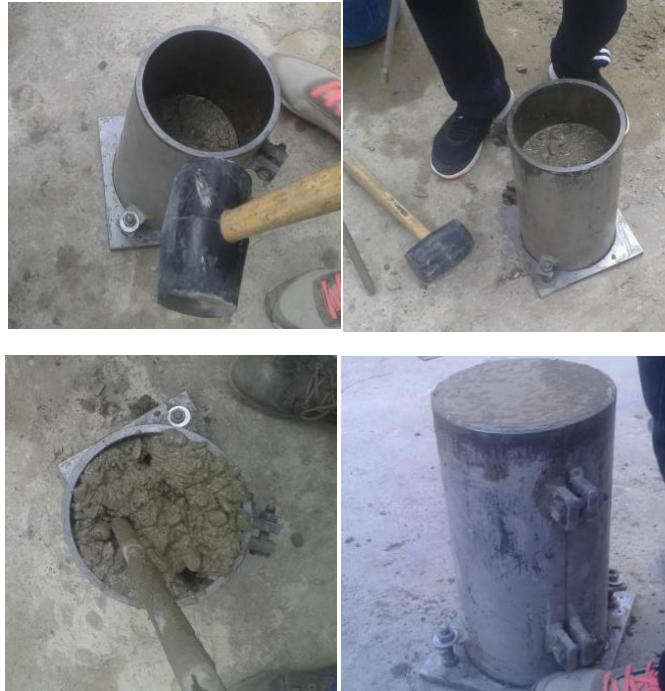
Figura 3.14 Compactación, vibrado manual y enrasado
