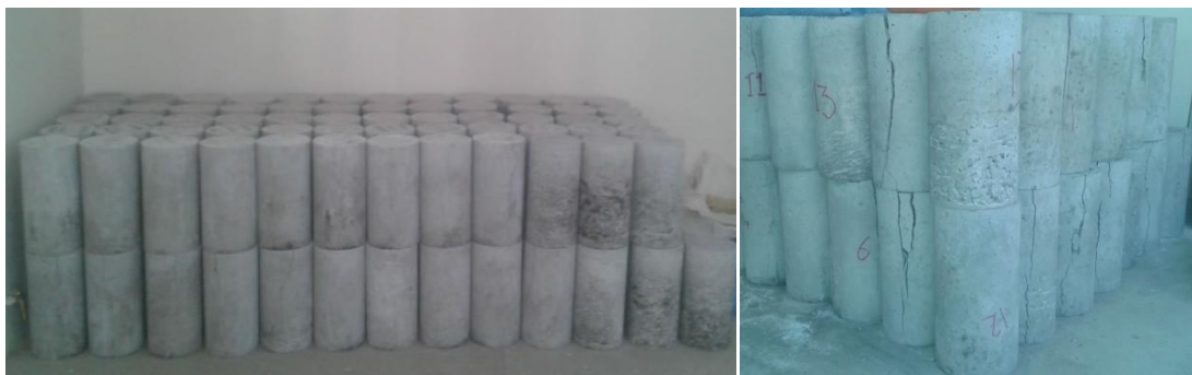
Figura 3.21 Probetas después del ensayo de compresión
