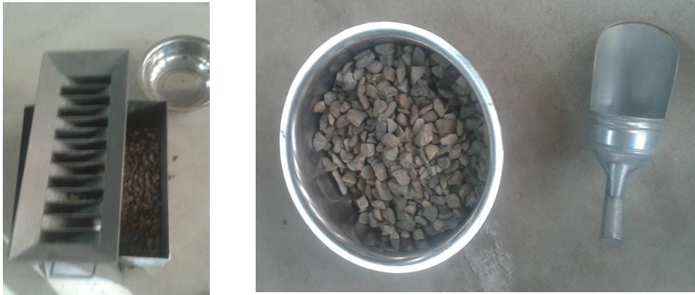
Figura 2.9 Cuarteo de la grava seleccionada
