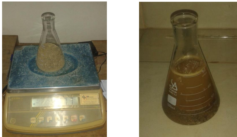
Figura 2.23 Pesada de la arena más matraz saturada de agua
