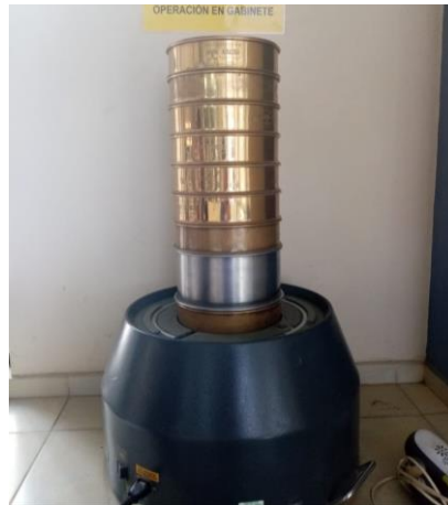
Figura 2.13 Tamizado de la arena en el vibrador mecánico
