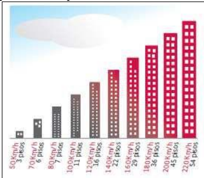
Figura 7. Comparación de choques a diferentes velocidades con caídas de altura.
