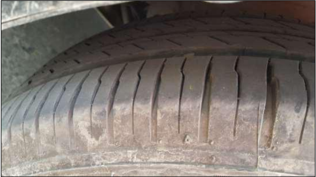
Figura 30. Verificación del testigo de fondo del neumático.
