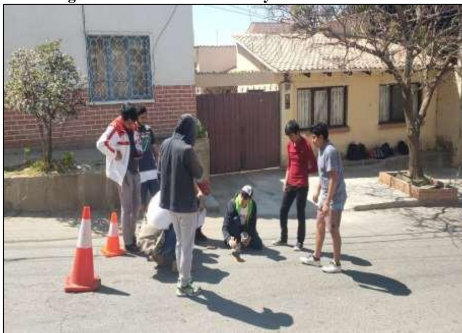
Figura 24. Realización de ensayo de círculo de arena.
