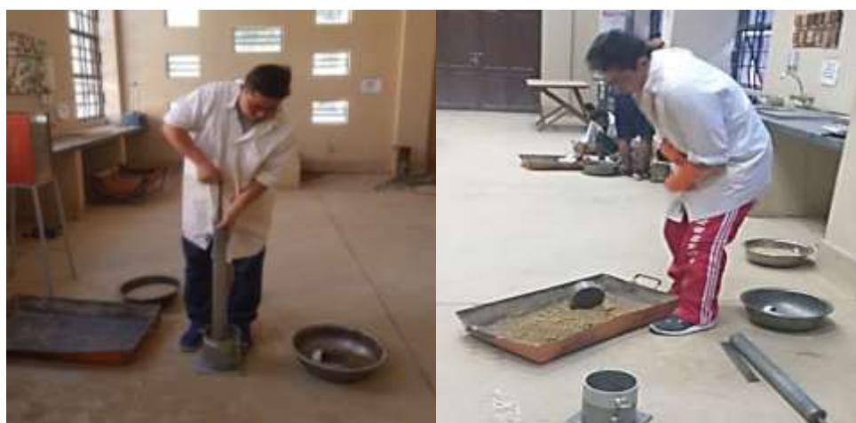
Figura 3.1.9 Proceso de compactación T - 180
