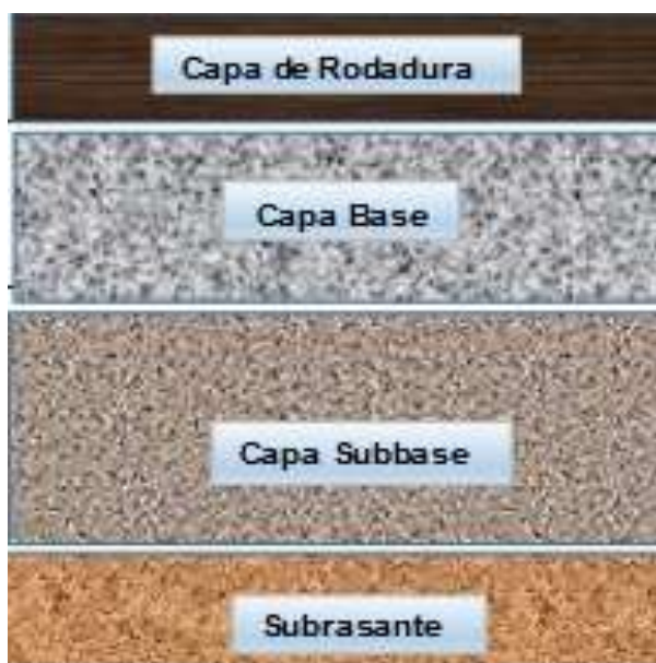
Figura 2.4.1. Estructura típica de pavimentos
