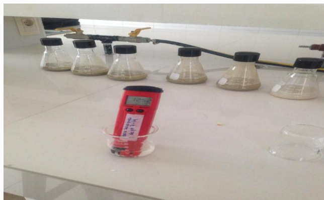
Fotografía 4. 13 Lecturado del pH para mezcla suelo-cal
