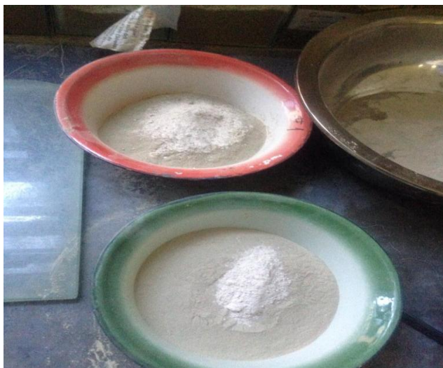
Fotografía 4. 14 Muestra de suelo más 4% de cal para ensayo de límites
