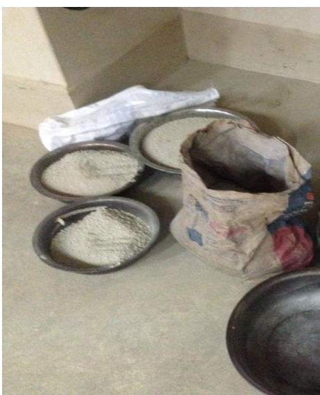
Fotografía 3. 15 Preparación de muestra para compactación T-99
