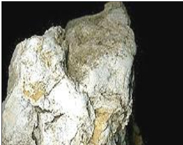
Fotografía 3.3: Montmorillonita (corresponde al grupo de las arcillas, mineral de los silicatos)
