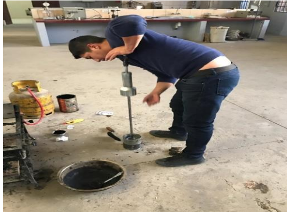
Figura 3.30. Proceso de compactado de briquetas
