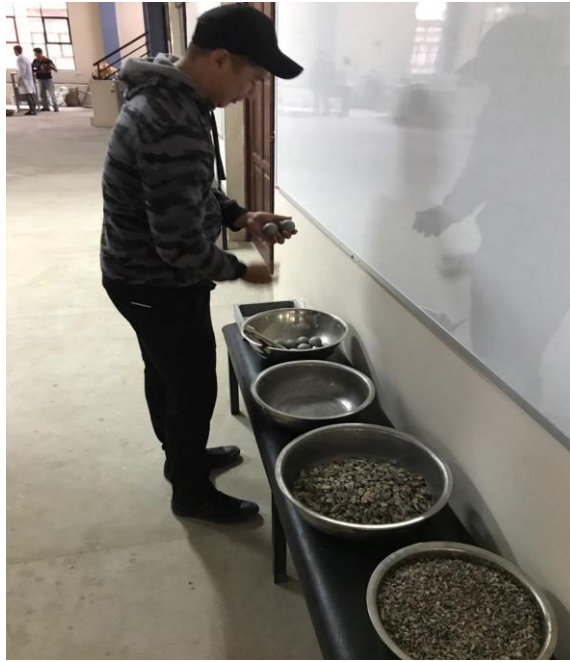
Figura 3.8. Material para el ensayo de desgaste de la máquina de los Ángeles
