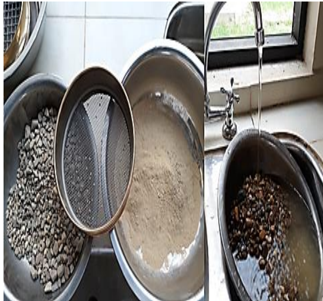
Figura 3.10. Muestra separada por el tamiz N°12 y lavada
