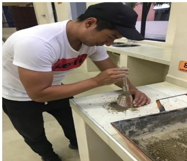
Figura 3.13. Verificación de la condición de la muestra saturada con superficie seca
