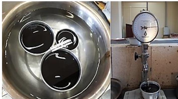
Figura 3.20. Ensayo de penetración
