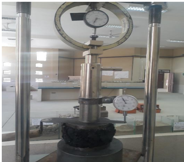
Figura 3.37. Prensa de CBR con los respectivos apoyos aplicando cargas cíclicas
