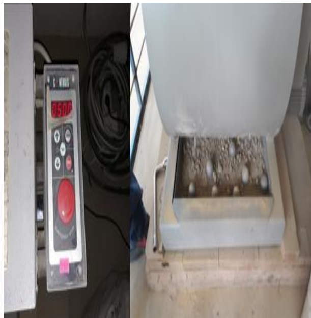
Figura 3.9. Muestra sacada de la máquina de los Ángeles a 500 revoluciones
