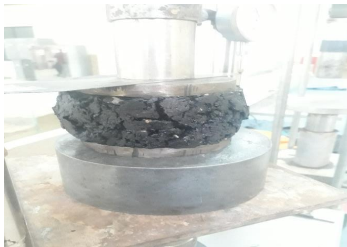
Figura 3.41. Comportamiento de la mezcla asfáltica después de 50 ciclos generados
