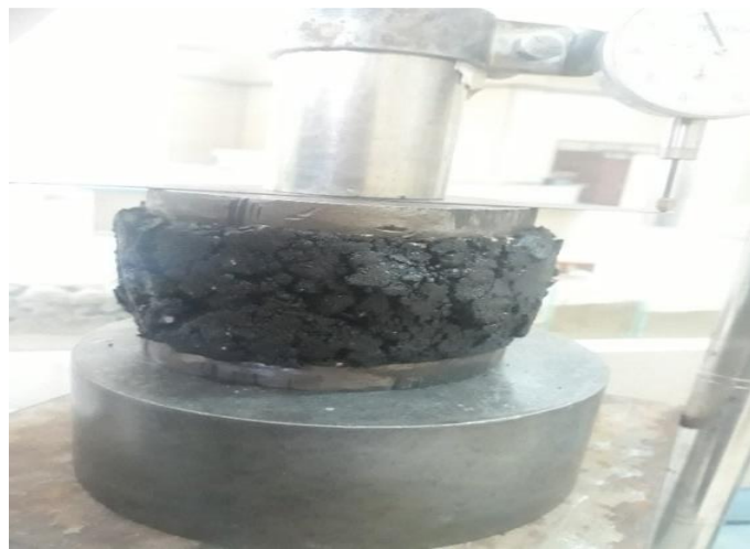
Figura 3.42. Comportamiento de la mezcla asfáltica después de 75 ciclos generados
