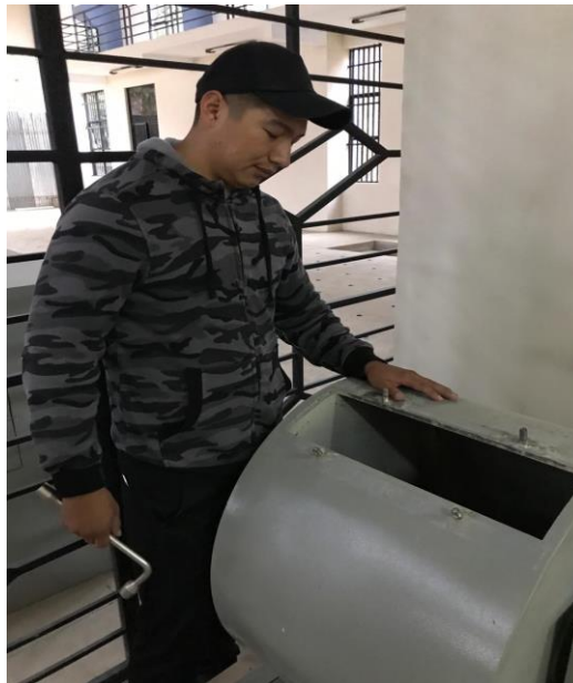
Figura 3.7. Desgaste por medio de la máquina de los Ángeles
