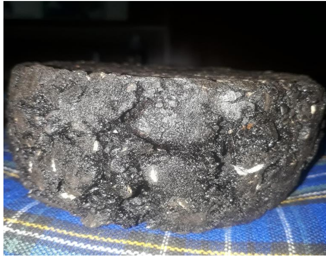
Figura 3.40. Comportamiento de la mezcla asfáltica después de 25 ciclos generados
