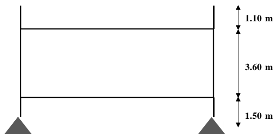
Figura 3.2. Idealización de la estructura L.F.
