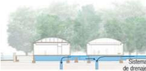
El sobrecimiento de hormigón, además de proteger al edificio de las condiciones climáticas, sirve como un sistema de drenaje de agua para contrarrestar las inundaciones estacionales.
