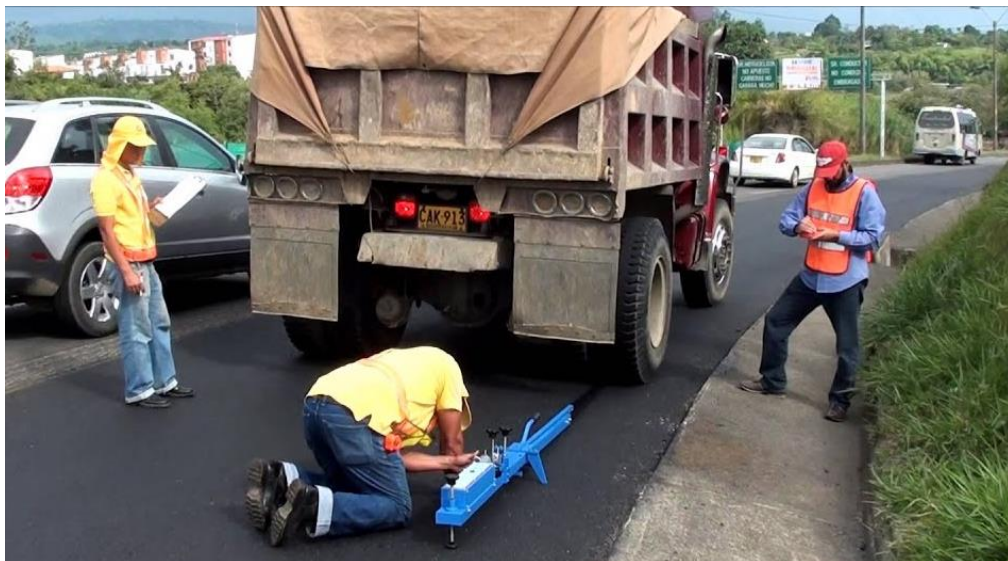
Figura. 2.15. Ensayo den la Viga Benkelman
