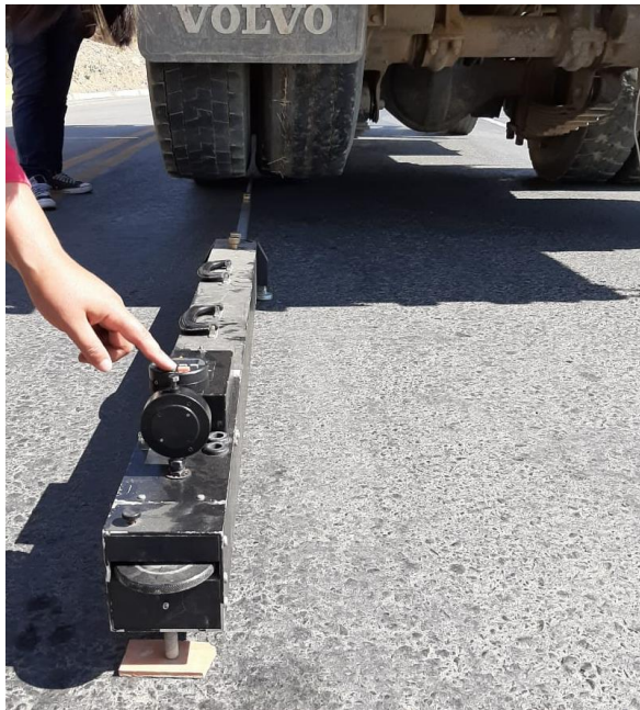
Figura. 3.27. Colocado a 0 el dial.
