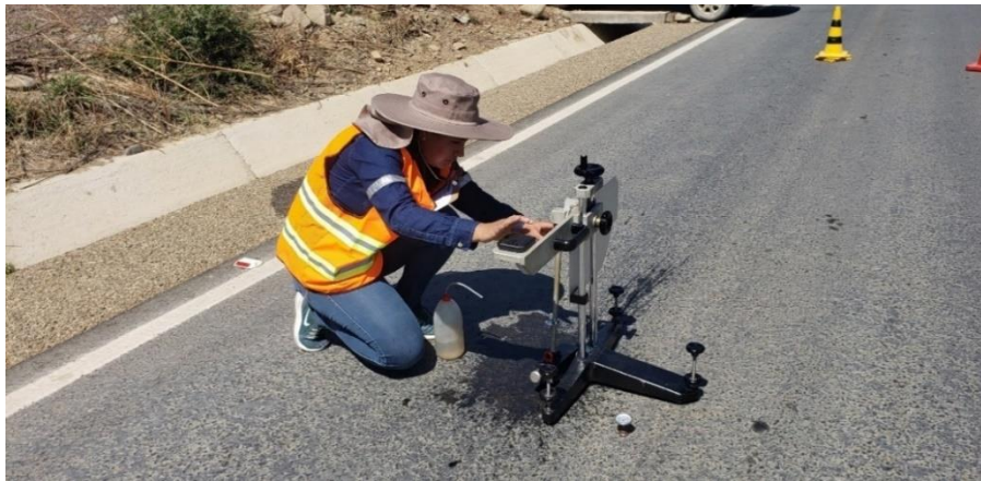
Figura. 3.16. Ensayo péndulo Británico.
