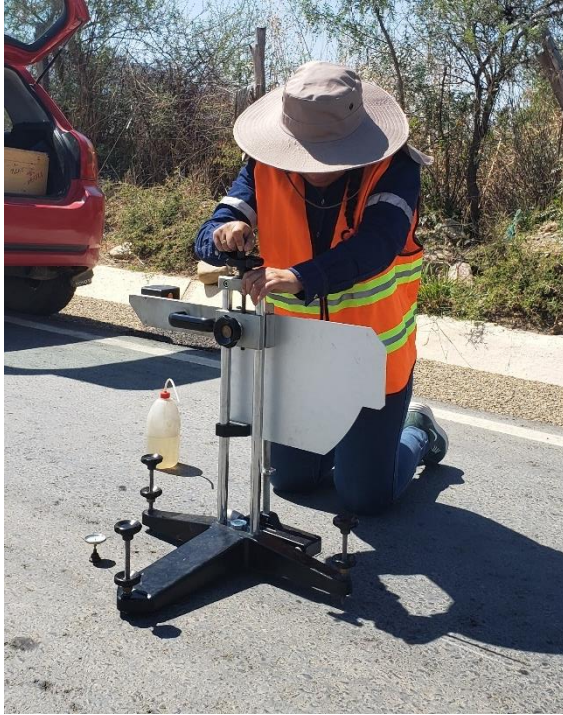
Figura. 3.13. Calibración del péndulo Británico.
