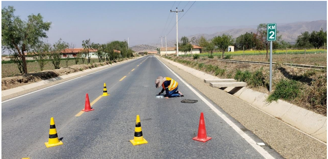
Figura. 3.12. Realizando el ensayo del círculo de arena.
