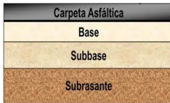
Figura. 2.2. Capas del pavimento flexible.
