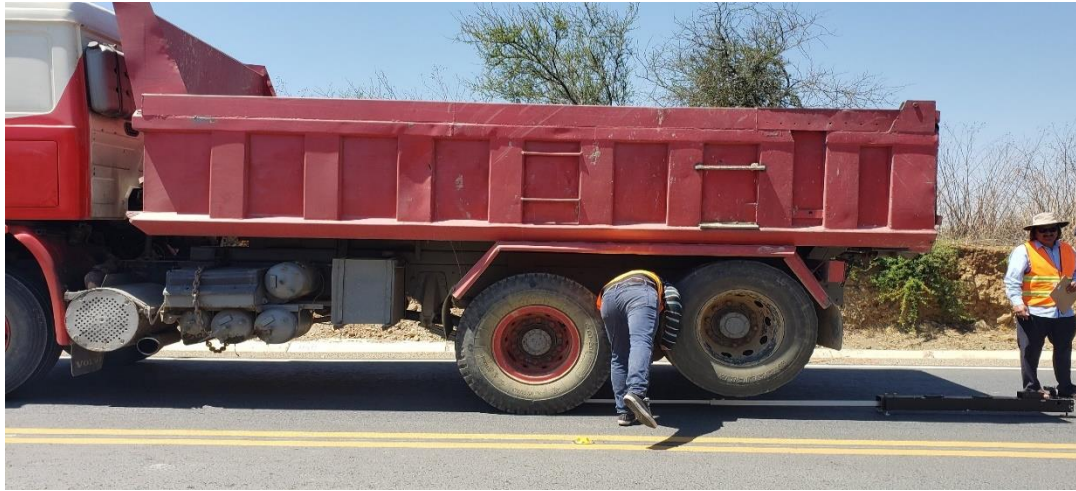
Figura. 3.26. Posicionamiento de la viga Benkelman.
