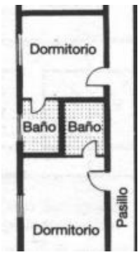
Baño entre dos habitaciones
