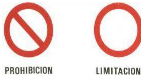
Figura 2.15 Forma y color de señal restrictiva
