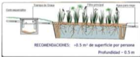
Ilustración 5. Sistema de reutilización de aguas grises tipo jardinería
