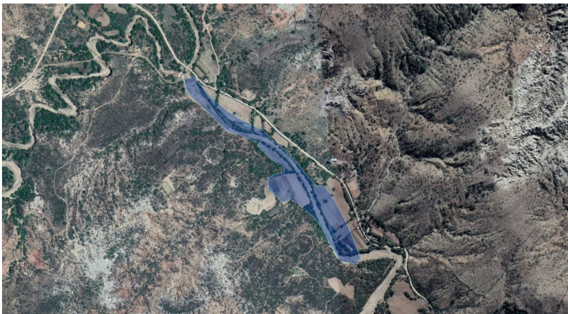
Figura 4.13 – Vista satelital área de inundación, T = 50 años.
