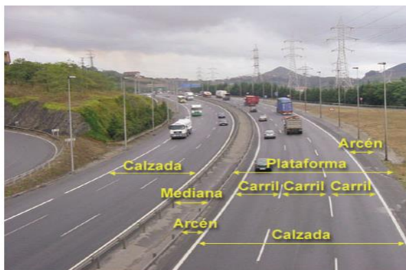
Figura 2.3 Partes de una vía urbana.
