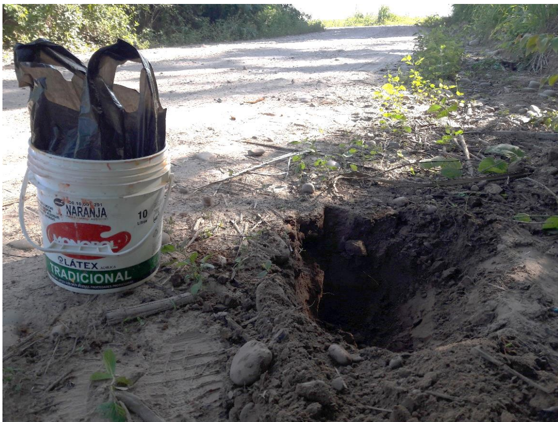
Imagen Nro. 5: Extracción de muestra de suelo en zona cercana al puente
