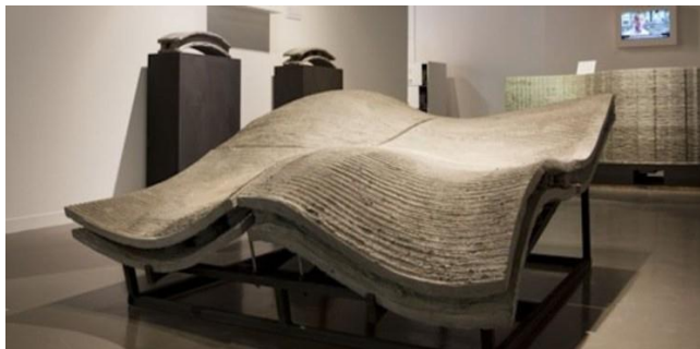
Figura N°5 Cubierta de concreto y textil.
