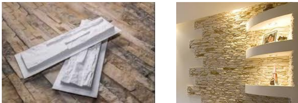
Figura N° 17 Molde para piedra artificial y revestimiento artificial
