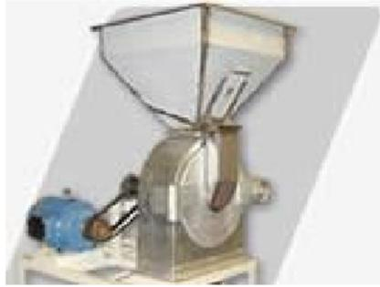
Construido en acero inoxidable AISI 304 Dimensiones: 0,35x0.5x1, 2, altura máxima de 1,50m. Molino rotor de 350mm de diámetro con 84 martillos pequeños. Dispondrá de una tolva de carga en acero inoxidable de 1 mm de espesor, con una compuerta regulador de dosificación.
