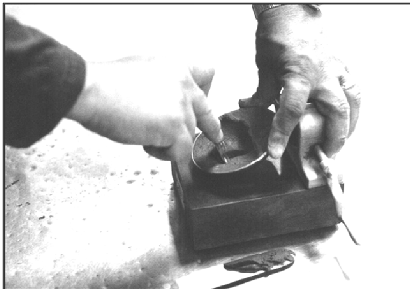
Imagen 3.1 Aparato de Casagrande
