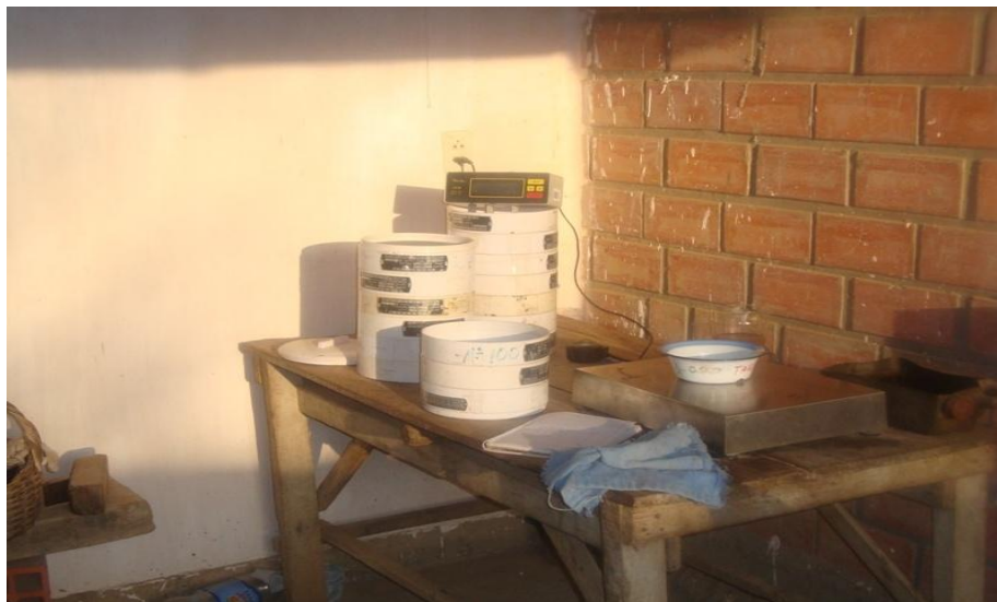
Fotografía 4.15 Serie de Tamices y Balanza
