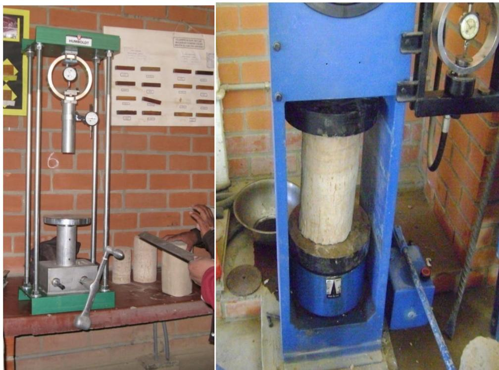
Foto 3.3 Prensas utilizadas para realizar el ensayo de compresión simple
