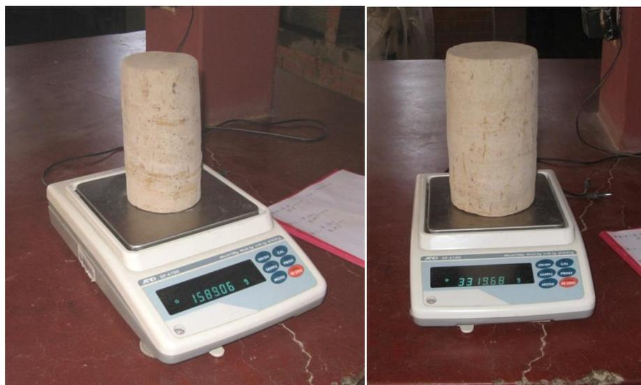
Foto 3.2 Pesado de probetas de suelo
